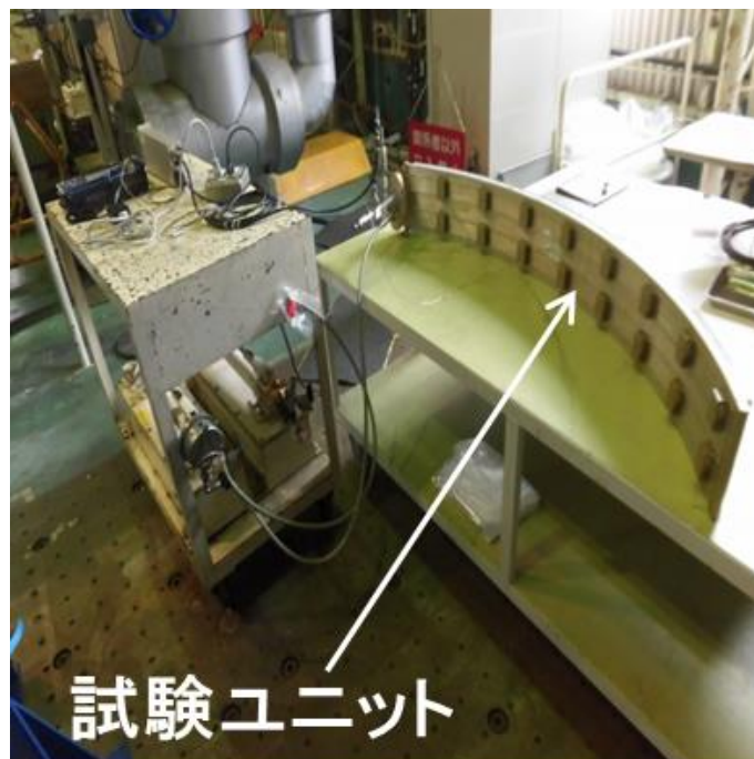
破壊圧試験セットアップ
