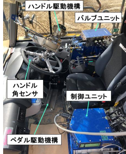
簡易後付けの足踏駆動機構
