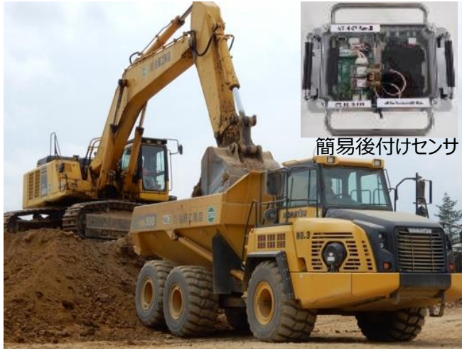
大型ダンプの後付け自動化装置による自動化
