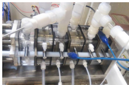
図 3.1.1.9 逆電流評価用バイポーラ型標準電解槽
