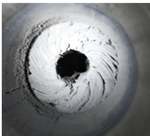
図 5 触媒筒に固着した生成炭素
