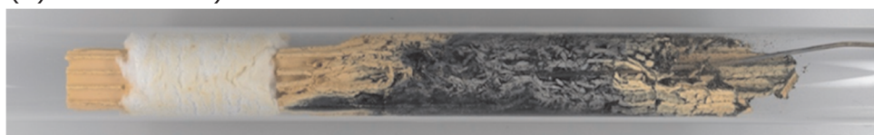
(1) 改良前の脱硫剤 (試験後には炭素析出により流路が損壊)
