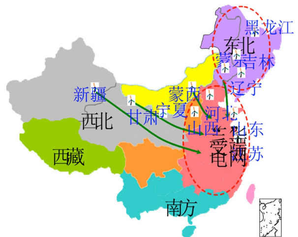
図 1. 中国の風力発電の建設で新たな送電線が必要になった例。消費の少ない中国北部に大規模な風力発電所が計画されている。電力を大規模需要地に輸送するために、超高压送電線が計画されている。(出典: SGERI).
