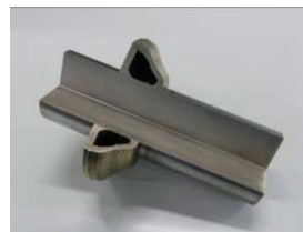
複層造形体の例(シャフト) (合金鋼+SUS316L+ステライト)
