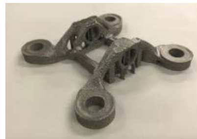
三次元擬似形状モデル (Ti-6Al-4V)
