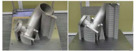
大型パイプモデル (INCONEL718) (400mm×350mm×350mm)
