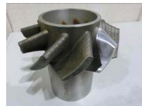
複層造形体の例 (回転部品) (SUS304+インコネル 718+マルエージング鋼)
