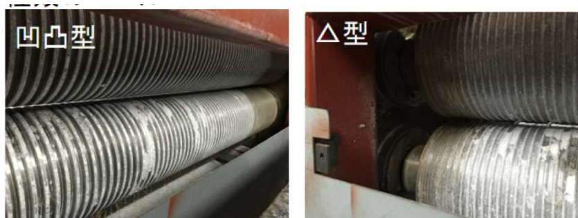
図Ⅲ-2-②-(3)-5 ロールの形状(左：凹凸型、右：△型)
