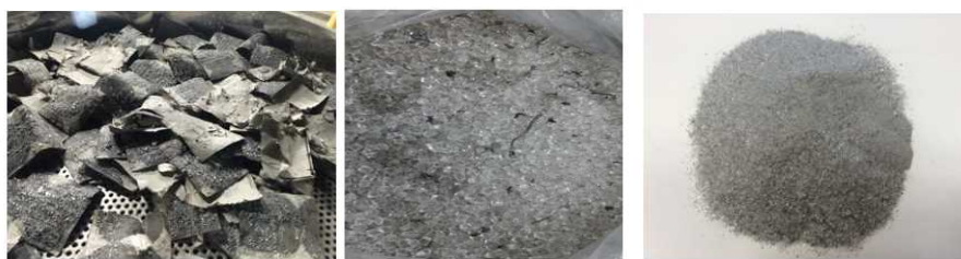
図III-2-②-(3)-11 回収物(左：セル屑、中央：ガラスカレット及び金属片、右：微粉)
