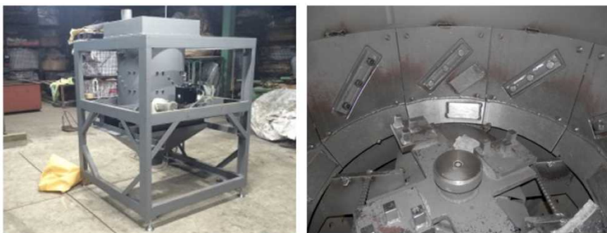
図Ⅲ-2-②-(3)-7 ハンマー式破碎剥離機 (左：外観、右：内部)
