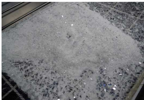
図Ⅲ-2-②-(3)-4 ロール式破砕機処理後の太陽電池
