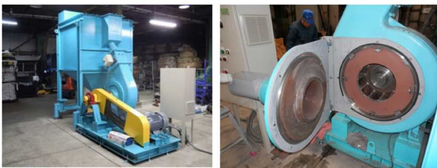
図Ⅲ-2-②-(3)-8 遠心風力式破碎機 (左：外観、右：内部)
