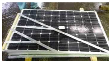
変形・破損なし
