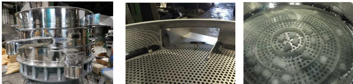
図III-2-②-(3)-10 分級機 (左：外観、中央：パンチングメタル、右：メッシュ)
