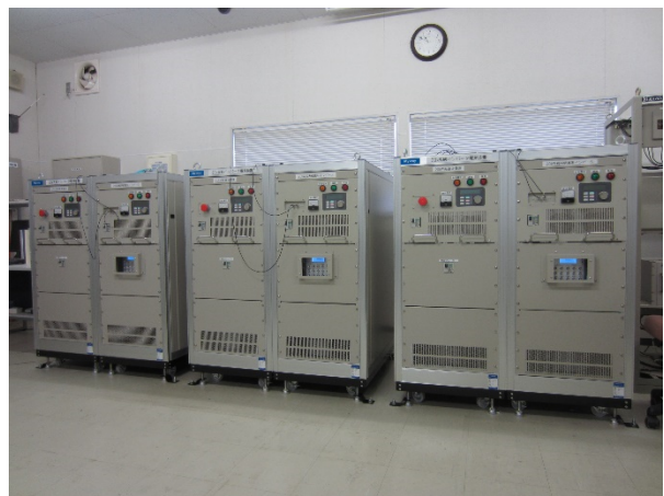
図 5.4(2)-3 20kW 級大規模 PV 模擬電源装置
