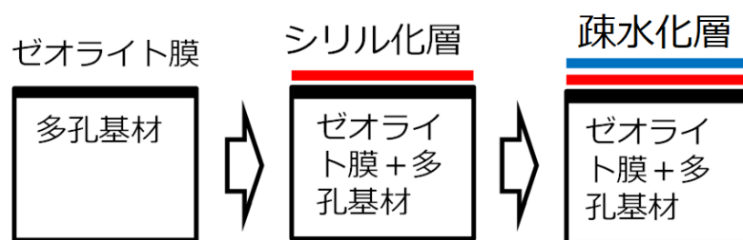
図Ⅲ.2.1.2.2.2-4 ゼオライト膜表面の二重修飾手順と膜の構造
