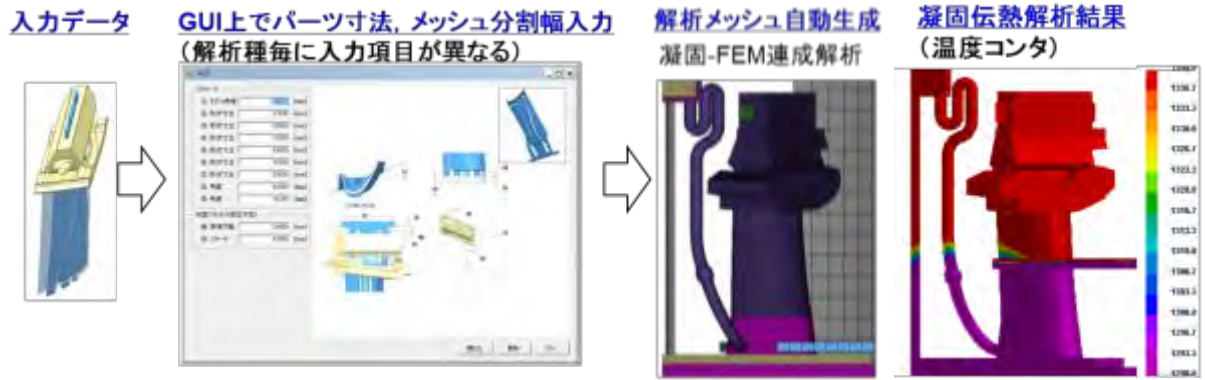
図⑩-1 凝固-FEM 連成解析モデル・メッシュ自動生成システムのフローと解析結果例
