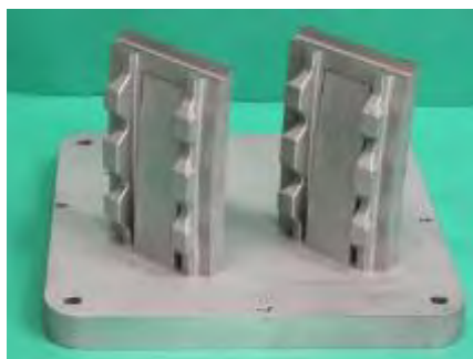
図⑨-4-1 3次元積層造形した GT 分割環
