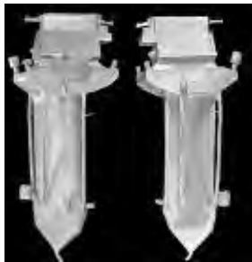
図⑨-1-1 単結晶試作翼
