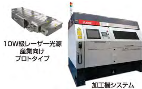
▼10W級深紫外・ピコ秒パルスレーザーを搭載した加工機システム(プロトタイプ)
