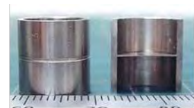
熱伝導溶接機により製作したステンレスのダイアフラム（左は完成部品、右は切断断面）
