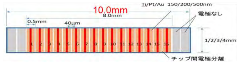
図Ⅲ2-3-5-6 16チャンネルを集積した、量子ドットレーザーアレイ構造（上面図）
