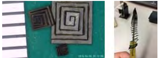
図Ⅲ2-4-1-1-11 フェムト秒レーザーによる CFRP の加工 (バネ精密加工例)
