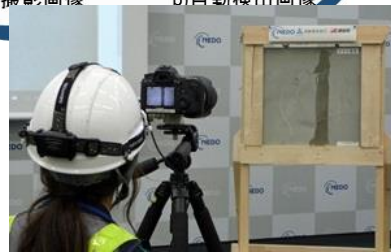
ひび割れ自動検出システム 2017.8.3
