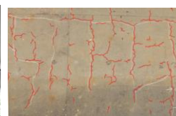
ひびわれ自動検出の結果
