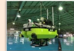
ダム点検用 水上・水中ロボット
