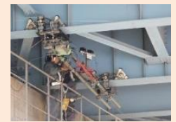
橋梁点検用 懸垂型移動ロボット
