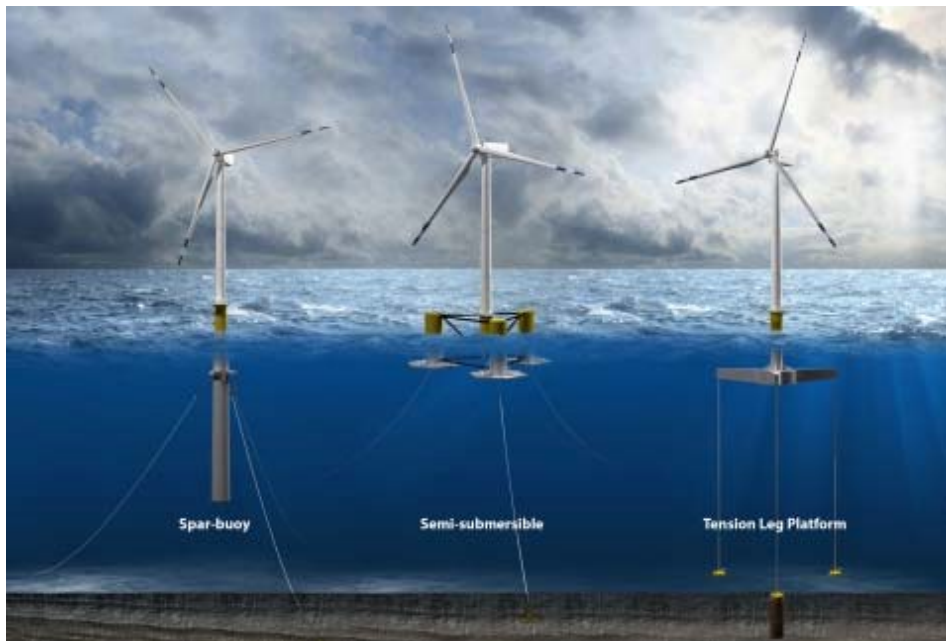
図 7.1-1 浮体式洋上風力発電の分類 39
