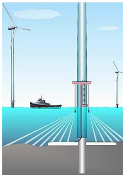
図 3.3.7-7 2 軸スキャニングソナーシステムの概要
