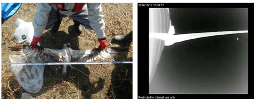
図4.2.2-7 当該洋上風車に衝突したミサゴと衝突感知システムで捉えたミサゴ
