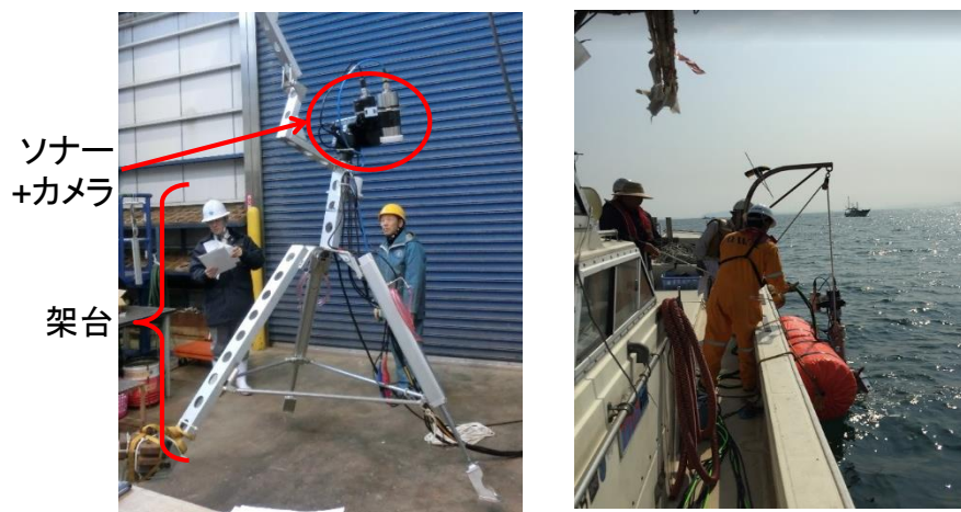
図Ⅲ.7.3-6 水中メンテナンスロボット (左：性能確認試験状況、右：海域への投入状況)
