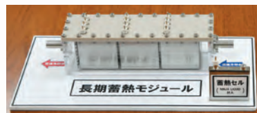
長期蓄熱モジュール（熱交換器）を用いて、長期蓄熱材料に蓄えた熱を自動車のエンジン冷却水等に伝えて使用する。
