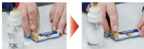
液体のまま熱を蓄えた長期蓄熱材料（左）に1.5Vの電圧を加えると固体となり（右）、必要なタイミングで熱を取り出せる。
