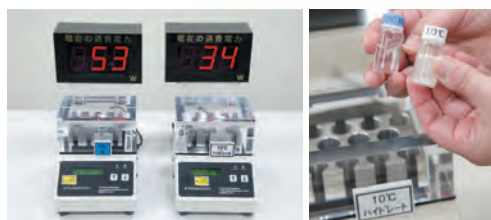
10℃前後のニーズに対して、高密度蓄熱材料（右）は、氷（左）より高い温度で固体となり、熱を貯めることで、消費電力を低減できる。
