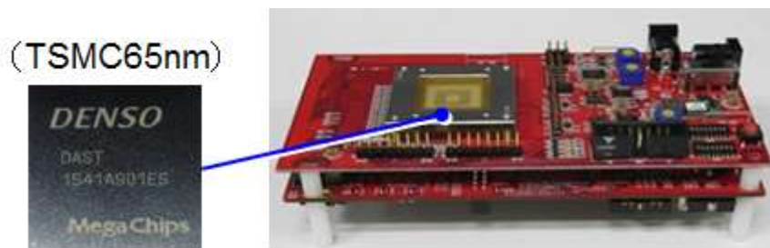
図Ⅲ-2.1.1-19 信号処理 LSI プロト (SoC) と評価装置外観
