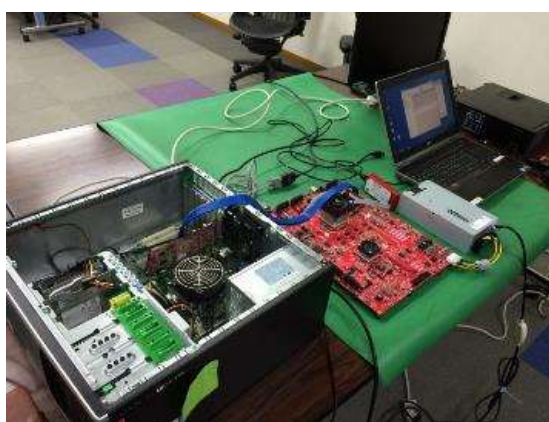
図Ⅲ.2.2.1-5 画像意味理解プロセッサ技術を実装した FPGA 搭載ボードを用いた評価環境
