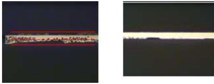
(a) ステップカット時 (条件1) (b) シングルカット時 (条件5)
