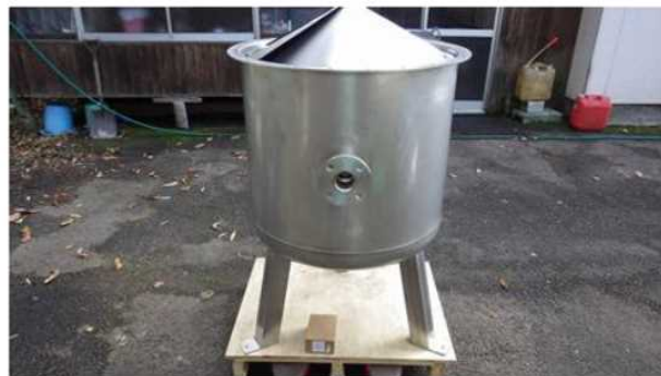
図Ⅲ(2.2)-5.左)二次試作機外観 右)二次試作機蒸気流入部
