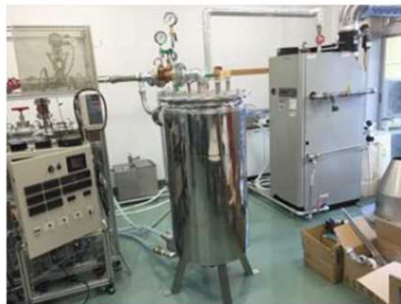
図Ⅲ(2.2)-2.設置した一次試作の気水分離器機
