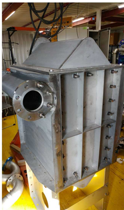
図Ⅲ(2.4)-11. 本研究で開発したプレート型熱交換器
