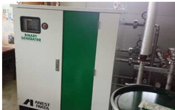
図27 バイナリー発電システム(試作機: 3kW級パッケージ)
