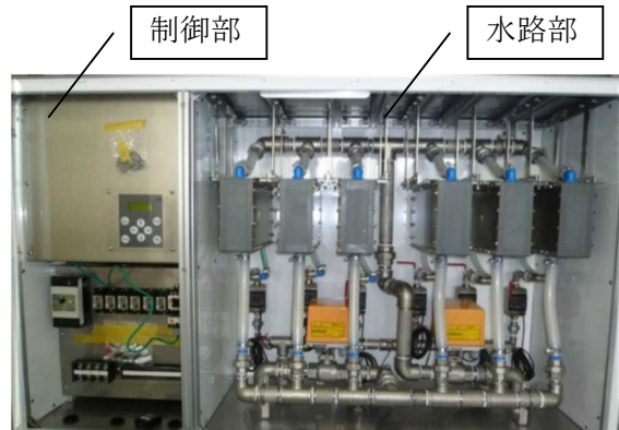
図 II (2.8)-6 無隔膜電解式評価装置 1 (電解水生成量が 70(l/min))
