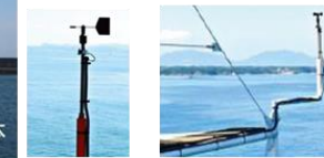
風況調査 (左:風向計, 右風速計)
