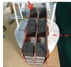
図3-35 水冷高周波変圧器と熱流解析結果
