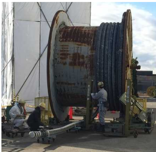
図 3-5-6 ダイナミックレイティングの検証の為に作成した DC500kV ケーブル
