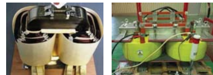
5 kVA 試作器 500 kVA 試作器 図3-36 試作した高周波変圧器
