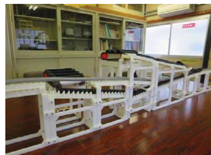
図3-25 高速船上防護管取付工法パラインの1/10モデル(3Dプリンタ模型)
