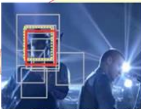
【黄色:正解、赤色:提案法、灰色:比較対照】 能動的に画像特徴を抽出しながら動画中で見え方が激しく変化する対象物体を追跡
