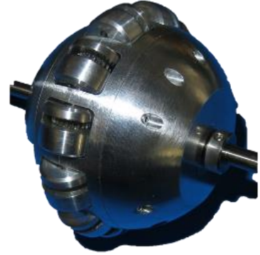
スクリー式回転差動機構による全方向駆動車輪
