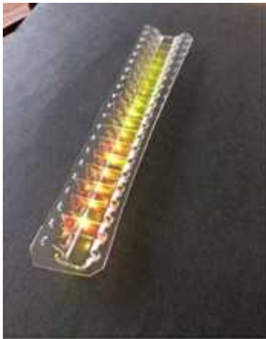
図Ⅲ-2-③-15-3 露光試作したホログラム外観
