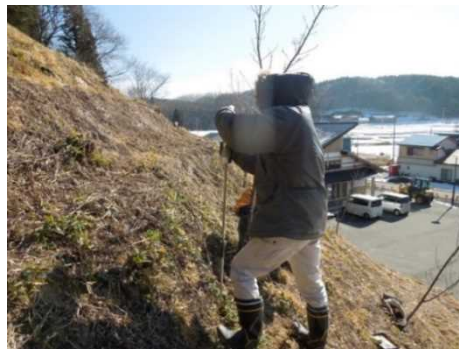
図Ⅲ-2-①-7-2 簡易動的コーン貫入試験状況
