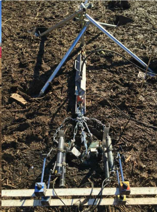
図Ⅲ-2-②-11-7 引抜き試験装置全景 図Ⅲ-2-②-11-8 水平載荷試験装置全景
