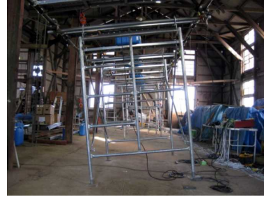
<図Ⅲ-2-①-18-6 : 台風を想定した引張試験>
