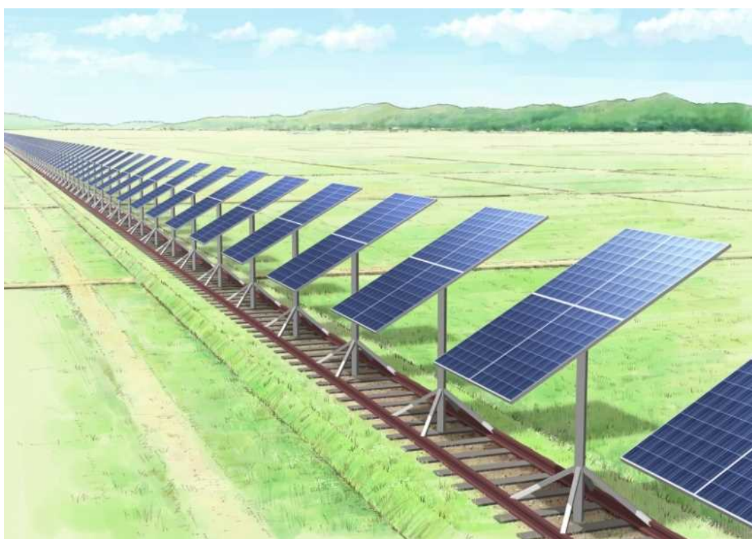
図Ⅲ-2-②-10-32 廃線跡を利用した追尾式太陽光発電
