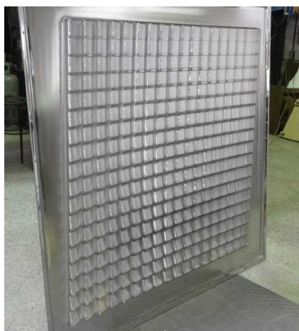
図Ⅲ-2-③-13-1 軽量化した圧空成型(樹脂成型)した集光ミラー
