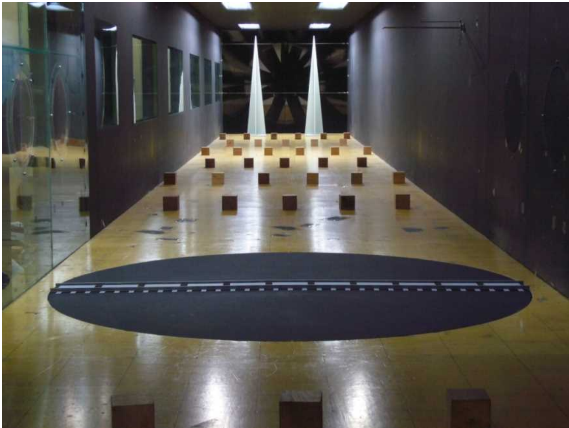
図Ⅲ-2-②-10-12 模型による風洞実験風景
