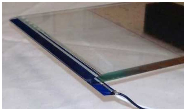
図Ⅲ-2-③-15-20 Holo Grass 原理試作ユニットの端面に配置される太陽電池セル部
