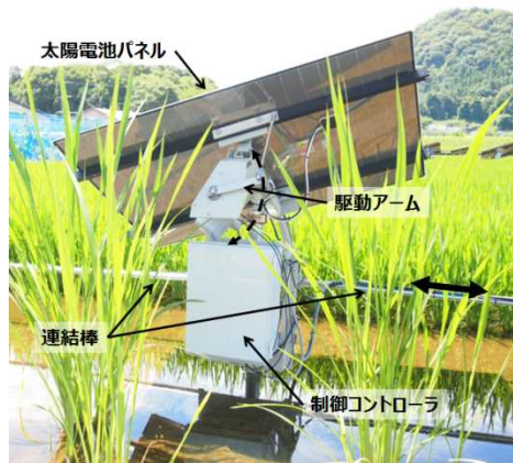
図Ⅲ-2-①-2-3 田に設置した太陽光追尾システムの駆動部
