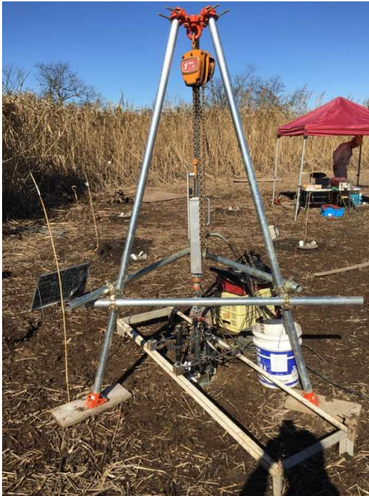
図Ⅲ-2-②-11-7 引抜き試験装置全景 図Ⅲ-2-②-11-8 水平載荷試験装置全景
