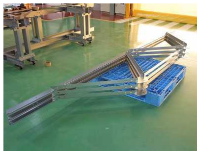
図Ⅲ-2-①-7-12 工場によるプレファブ化 (ユニット架台)
