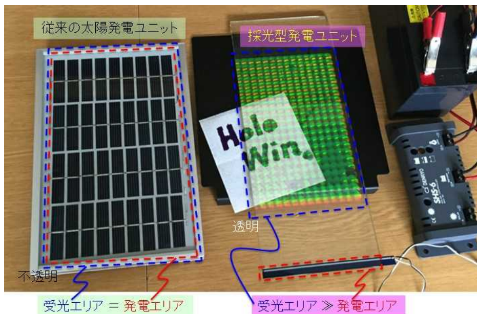
図Ⅲ-2-③-15-9 試作した採光型発電ユニットと従来型太陽発電ユニットとの比較
