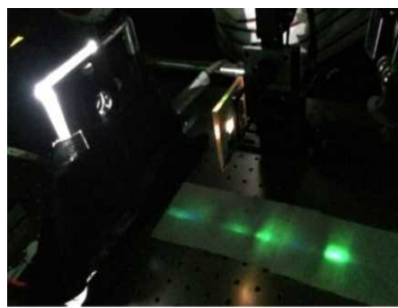
図Ⅲ-2-③-15-1 試作した鋭形化ガラス 図Ⅲ-2-③-15-2 端部からの光散乱
