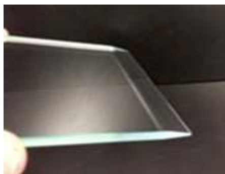
図Ⅲ-2-③-15-1 試作した鋭形化ガラス 図Ⅲ-2-③-15-2 端部からの光散乱
