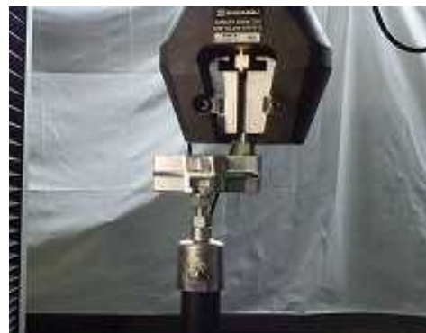
図Ⅲ-2-①-7-4 引張試験状況
