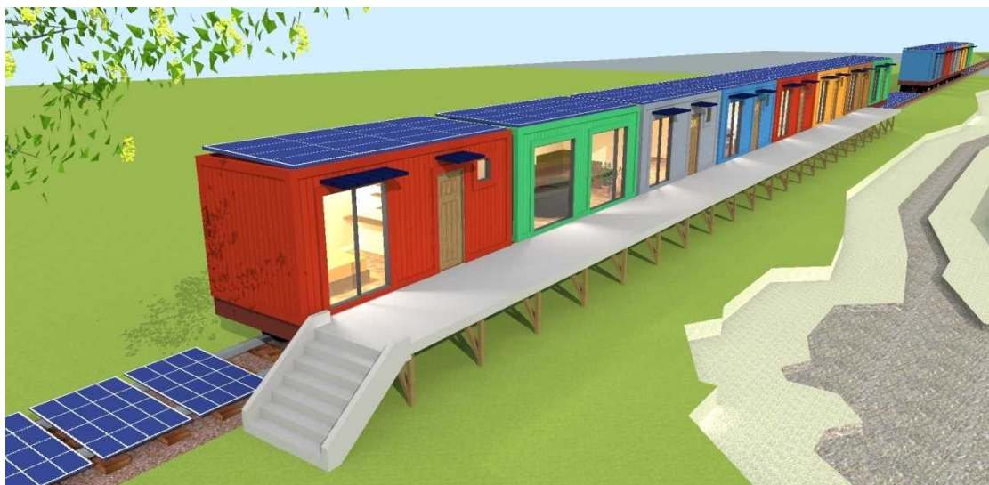
図Ⅲ-2-②-10-31 廃線跡に改装コンテナ+太陽光発電
