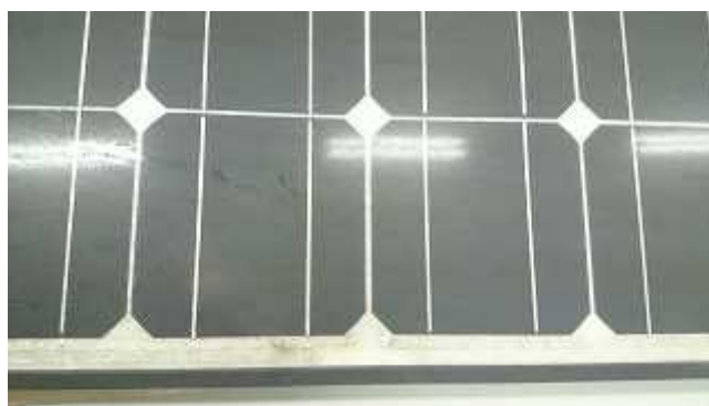
図Ⅲ-2-①-3-7 モジュール表面汚れ
