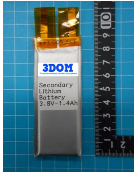
写真 4. 金属リチウム二次電池(プロトタイプ)
