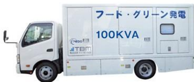
写真 5. バイオマス発電車
