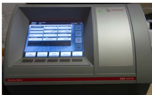
図 2.2.5-13 使用した精密密度計 (左) と Brij L23 の密度-濃度検量線
