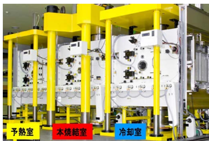
図 2.3.3-16 大型SPS装置外観
