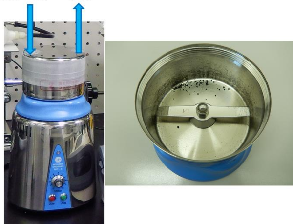
図 2.1.1-24 粉碎機の概要 上：ボールミル、下：フォースミル
