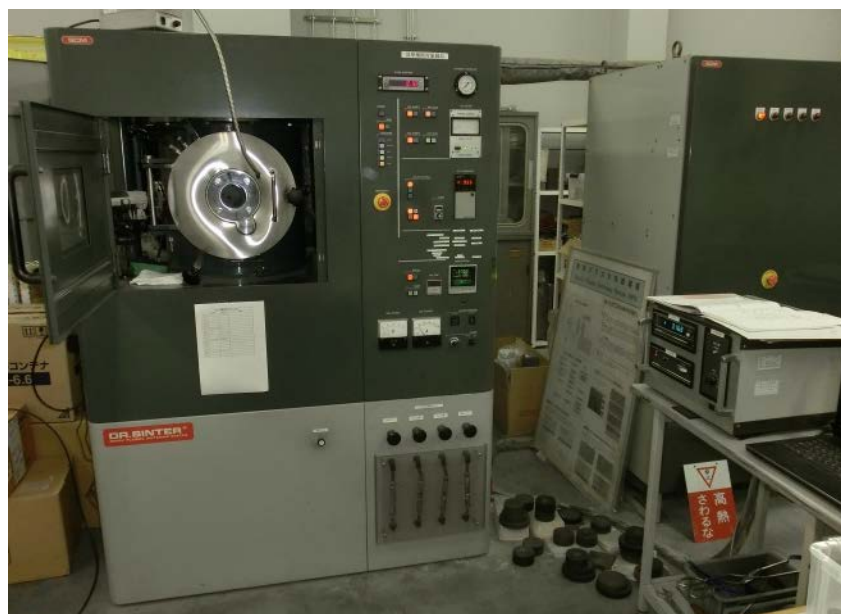
図 2.3.3-5 小型放電プラズマ焼結装置（SPS）外観 （大阪府立産業技術総合研究所保有装置）
