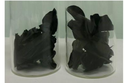
気管内投与試験に使用した半導体型 および金属型-単層CNT
