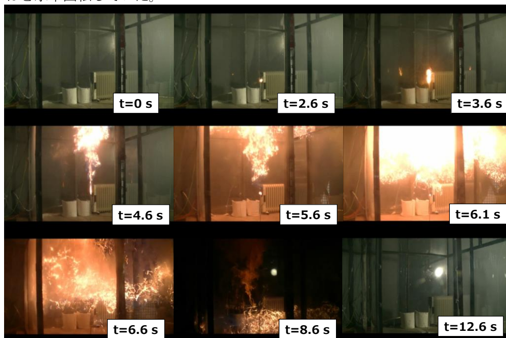
図 2.3.2.6-8 燃焼容器内での冷媒の着火および火炎伝播の様子 t : 通電からの経過時間 冷媒: R1234ze(E), 換気なし, 目標漏洩量: UFL 相当 (5.7 kg, 実際平均濃度 11.0 vol%)
