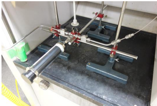
図 2.3.2.2-2 ASTM E659 試験装置写真 (左: プランジヤー装置、右: 銅箔付試験フラスコ).
