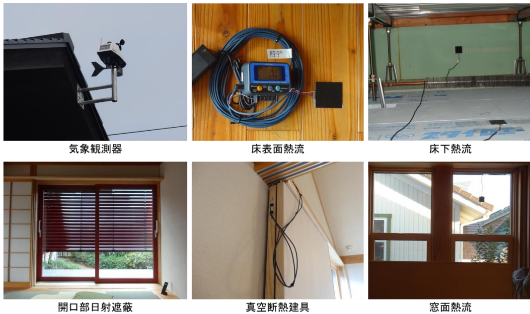
図 4 本研究開発の検証に用いた計測機器設置状況(概要)
