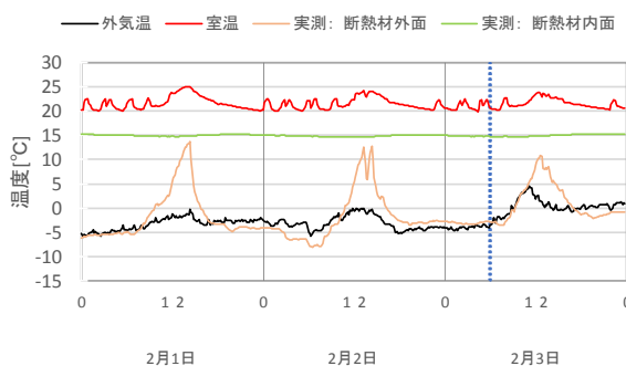
札幌：真空断熱材の室内外温度
