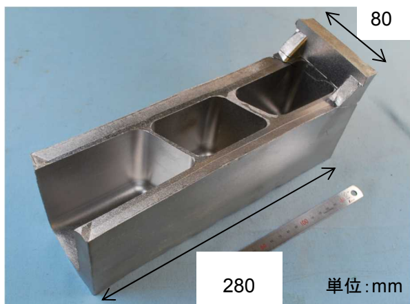
図5 コスト試算に用いた焼結体
