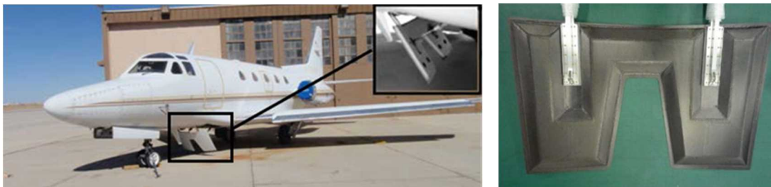
図 1.1.1-4 複合材製スピードブレーキ試作品
