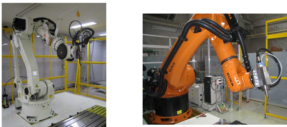
図 1 5 開発した切削ロボットシステム（左：搬送用ロボット、右：高剛性ロボット）
