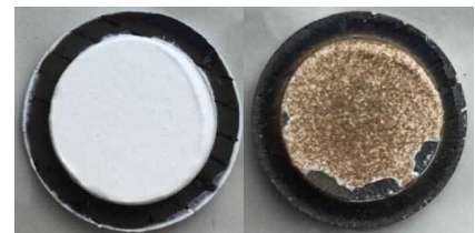
エロージョンスクリーニング試験後試験片外観(MS)
