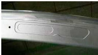
大型旅客機のフレーム部品は、アルミニウム合金の薄板材を多数のローラを用いて、S字断面やZ字断面を有する長さ数 m 程度の湾曲した形状に成型した後、深さ数 mm 程度のポケット加工を施して製造される。従来からポケット加工にはケミカルミリングプロセスが用いられている。
