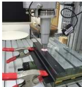
図 d.2.2-9 要素部材への大気圧プラズマ処理
