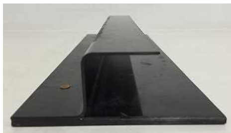
図d-2 部材試作および一体化接合試作品
