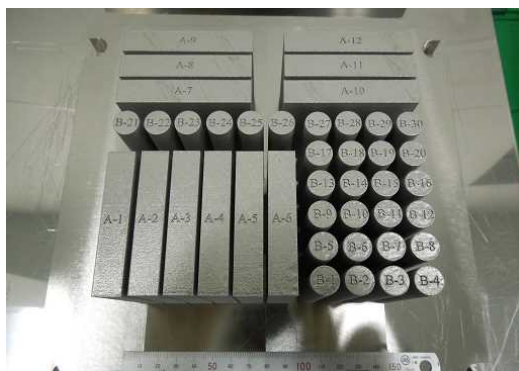
図7 付加製造による試作素材外観
