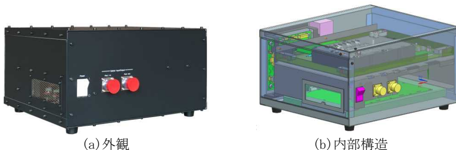
図 2.3.2-1 計測装置の外観と内部構造
