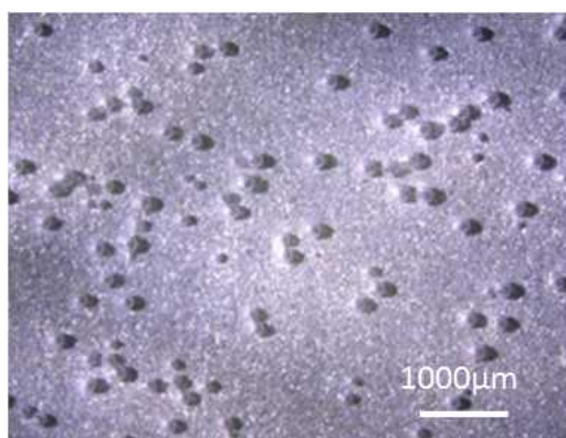
図Ⅲ.2.1.1.4-10 電極付着気泡評価装置により観察された、電極表面で発生した気泡
