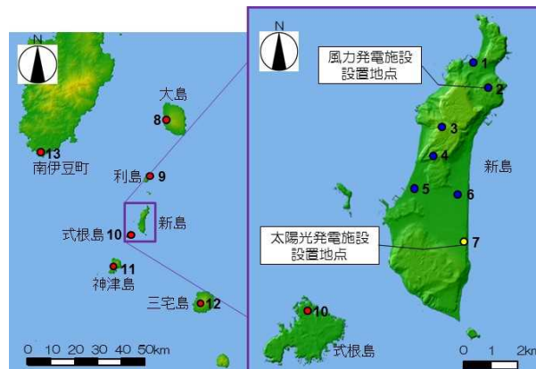
気象観測装置配置図 (新島と近隣諸島)
