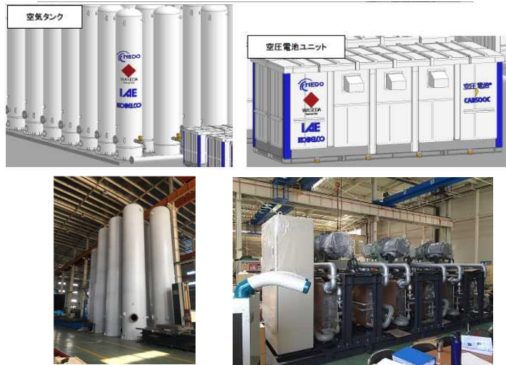
CAES実証システムイメージ(上段)と製造中の単品装置(下段)
