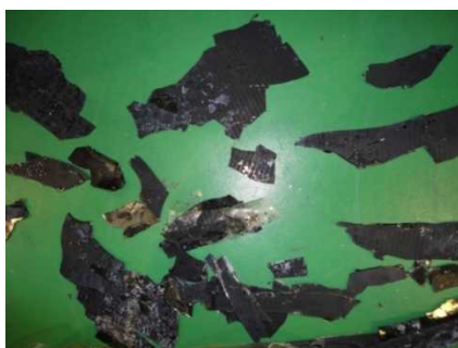
図Ⅲ-2-③-(4)-4 合わせガラスの予熱温度を高温化（約 270℃）した場合の基板ガラスのナイフの刃への到達前の割れ方 パネル送り速度：1mm/秒 ガラス片の大きさ：50～200mm×100～300mm 程度
