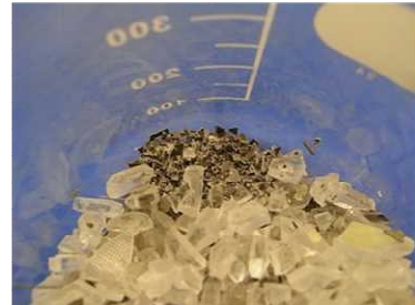
図Ⅲ-2-②-(4)-11 使用済み太陽電池モジュールから回収された金属およびシリコン
