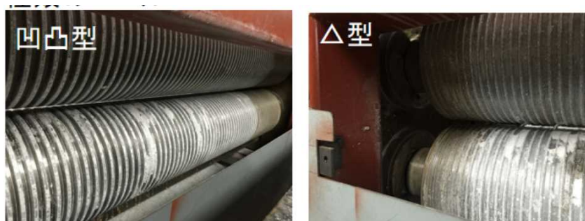
図Ⅲ-2-②-(3)-5 ロールの形状(左:凹凸型、右:△型)
