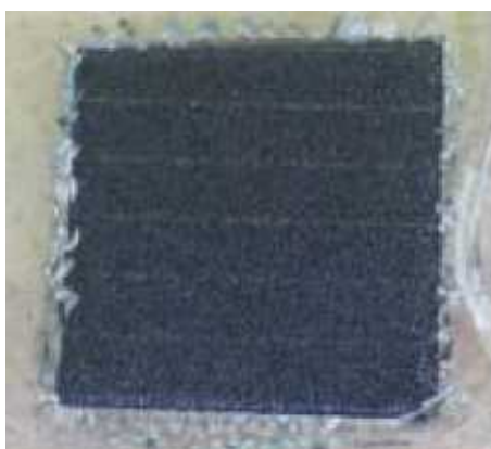
図Ⅲ-2-③-(4)-10 トルエン浸漬後の基板ガラス
