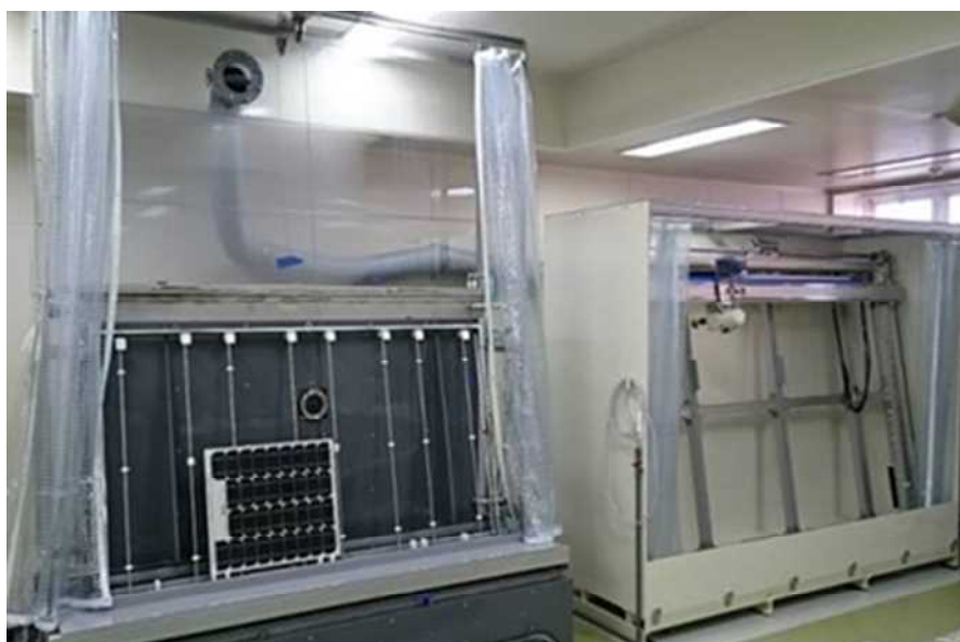
図Ⅲ-2-②-(2)-4 実験に使用した剥離装置 (左；剥離液浸漬ユニット、右；EVAのブラシ除去ユニット)
