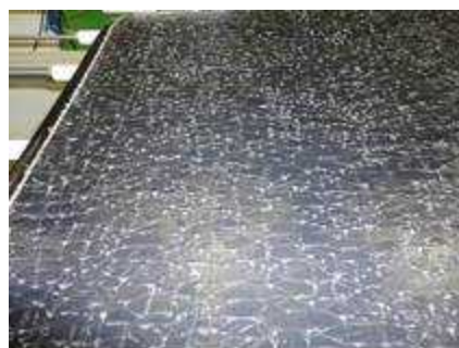
図Ⅲ-2-③-(4)-5 合わせガラスの予熱温度を高温化した（約 270℃）場合の基板ガラスのナイフの刃による割れ方 パネル送り速度：3mm/秒 ガラス片の大きさ：5～10mm×20～50mm 程度
