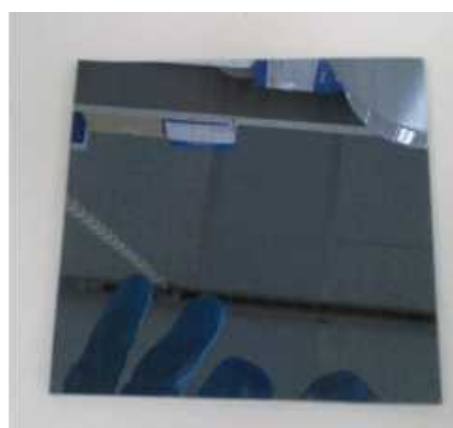
図 III-2-③-(4)-17 CIS 剥離後の基板ガラス (Mo 膜は残っている)
