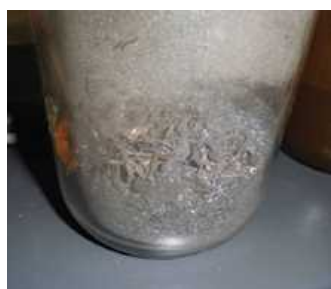
図Ⅲ-2-③-(3)-21 写真a):EVA/セル層 EVA 油化後の金属残渣
