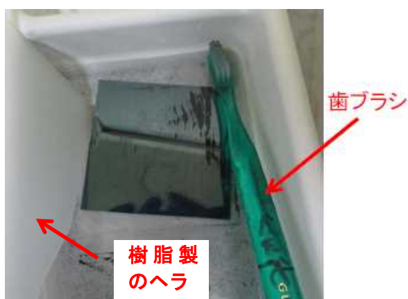
図 III-2-③-(4)-16 CIS 膜の物理的剥離試験 (6M NaOH 水溶液、60°C)
