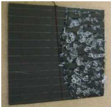
図Ⅲ-2-③-(4)-7 基板ガラスからの EVA の剥離実験 (7cm×7cm 基板ガラス、55°C、トルエン浸漬、2.5 時間)
