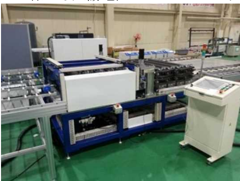
図Ⅲ-2-③-(3)-11 ガラス分離装置完成写真
