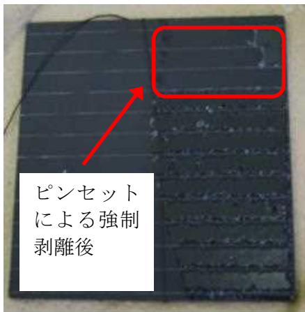
図Ⅲ-2-③-(4)-9 EVA の強制剥離後の基板ガラス (7cm×7cm 基板ガラス、55℃、トルエン浸漬、48 時間+超音波 8.5 時間)
