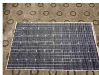
図Ⅲ-2-③-(3)-23 写真c):EVA/セル層 破砕なし
