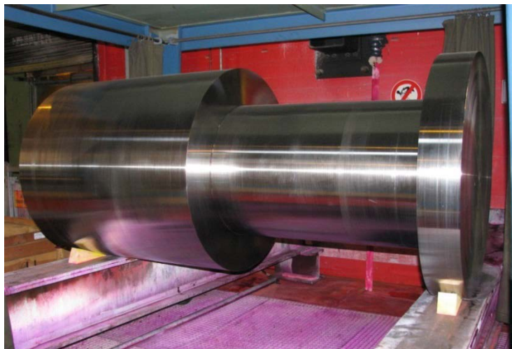
大型ロータの試作(重量:14ton) 東芝開発材 Ni基合金TOS1X-Ⅱ *注1)
