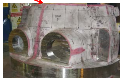
Alloy625 内部車室試作 重量 9ton
