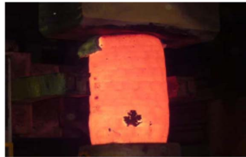
図 鍛造製造(据込)
