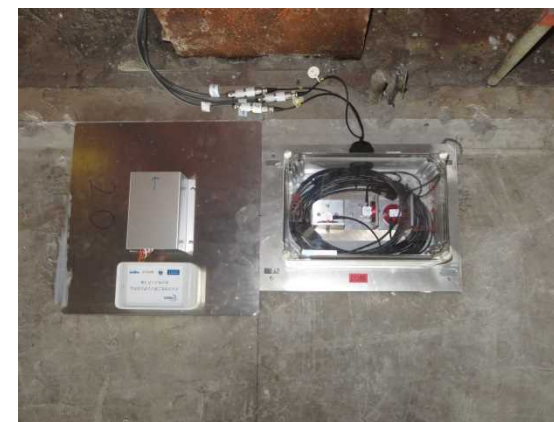
20階 加速度センサ設置状況
