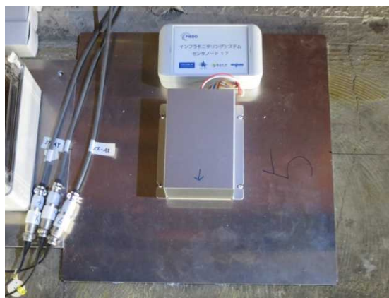
5階 加速度センサ設置状況
