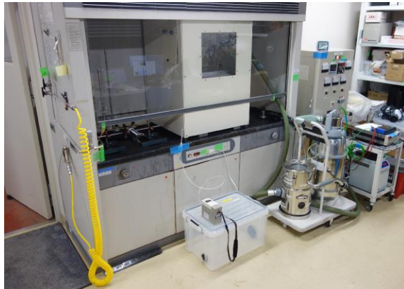
図 2.3.2.2-1 ASTM E659 自然発火試験装置概要.
