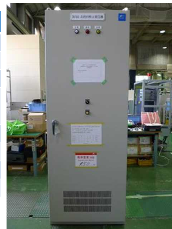
AVRユニットミニモデル (容量3kVA、200V) 外観
