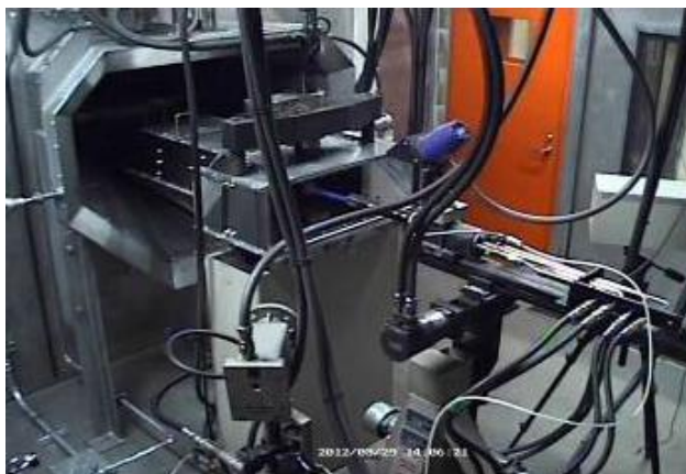
図5. 2-1 エロージョン(バーナー)試験機概略図 (高温・高速)
