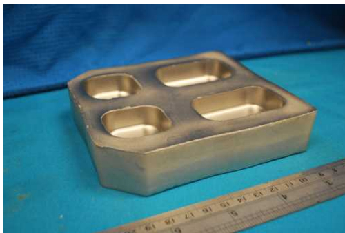
図 1 複雑形状焼結体の形状
