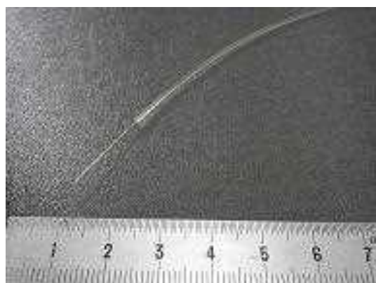
図 1.2.1-3 熱可塑樹脂被覆光ファイバ
