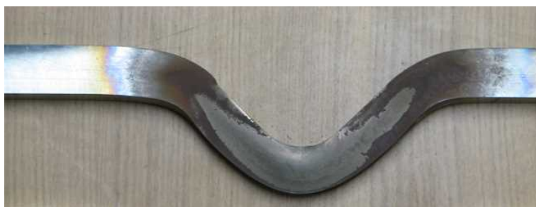
図 1 4 熱間ストレッチ成形のためのサブスケールサイズ試験片（曲げ試験後）
