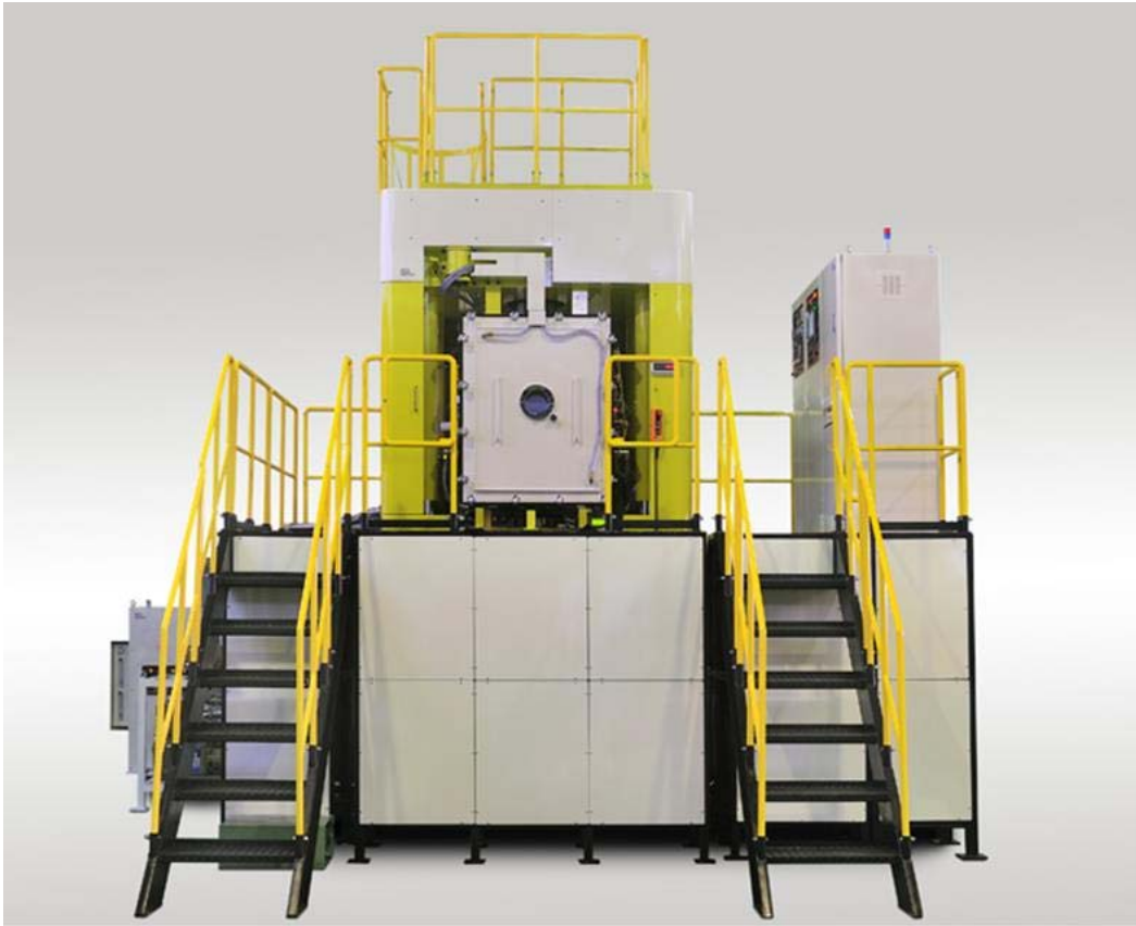
図 2.3.2.1-1 放電プラズマ焼結装置（SPS）外観
