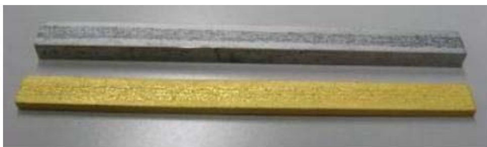
図 2.3.2.1-29 高熱伝導性材料に金メッキを適用
