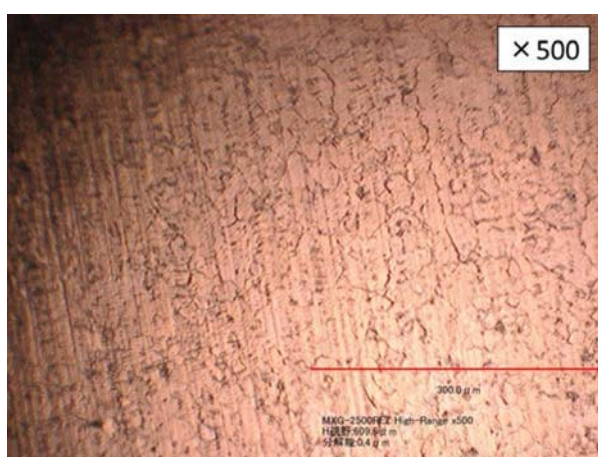
図 2.4.1-2-2-9 グラフェン合成に用いた銅箔表面の光学顕微鏡写真
