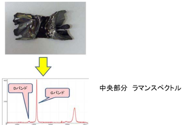
図 2.4.2-2-11 7.5 \mu\text{m} ポリイミドのみ(金属基板なし)を両端固定し、約 3000 ^{\circ}\text{C} で 1 分保持後のサンプル写真とラマンスペクトル
