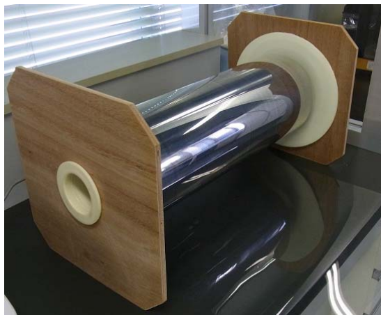
図 2.5.3-5 量産機塗工した単層CNTロールフィルム
