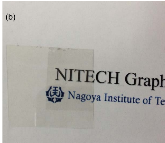
図 2. 4. 4-38 ショウノウから合成した (a) Cu 箔上のグラフェン膜 (b) 転写したグラフェン膜
