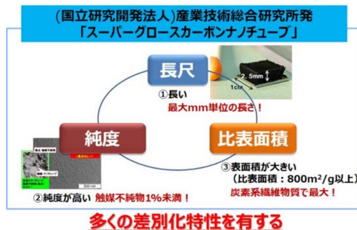
図4-1 スーパーグロスカーボンナノチューブの特性
