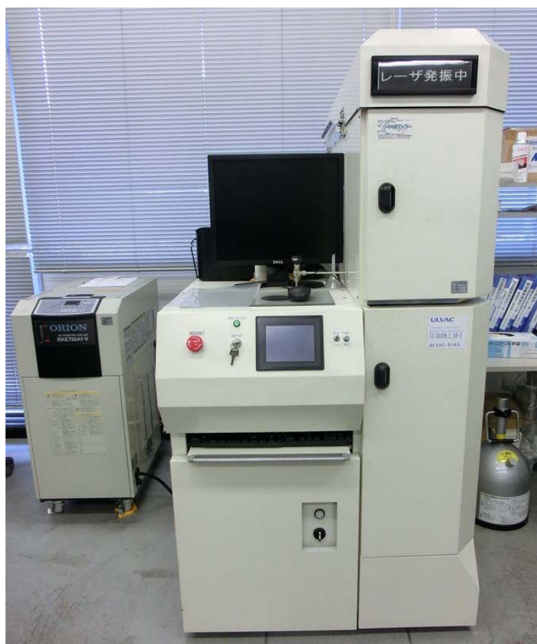
図 2.3.2.1-18 熱伝導率測定装置外観
