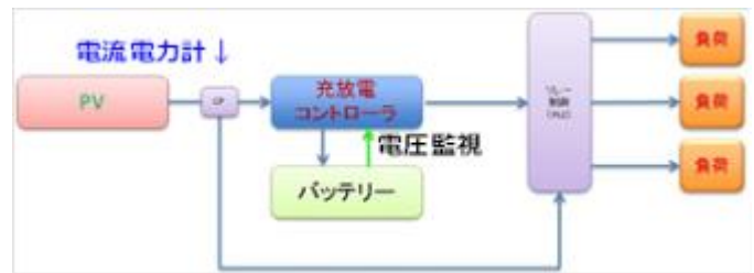
【図 Ⅲ-2-E-1-(2)】独立電源系の実証試験システム基本構成
