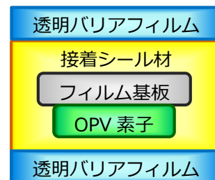
【図 Ⅲ-2-E-1-(7)】 シースルー OPV 封止構造
