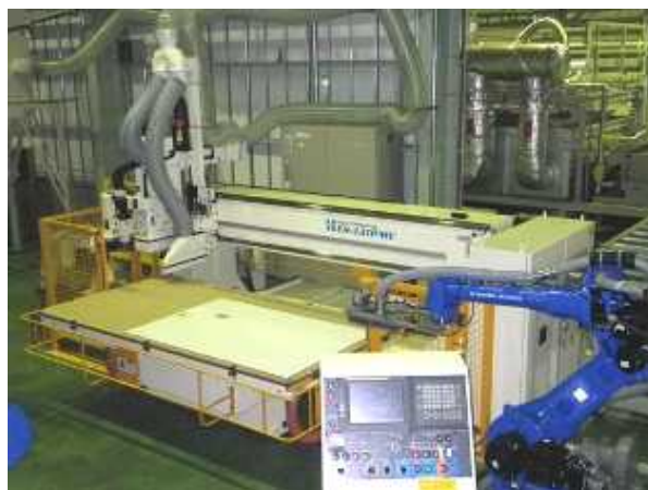
図Ⅲ-2-(へ)-E-1(1) 非加熱式バックシート剥離装置（構成図）
