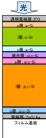
図Ⅲ-2-(ロ)-C-1(3) 2 接合太陽電池の構造
