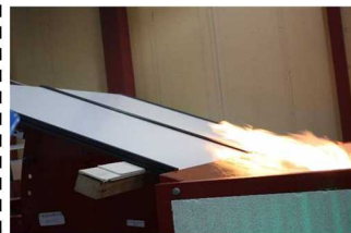
火炎試験中の様子 (炎の最も強い付近に樹脂製部品を設置)
