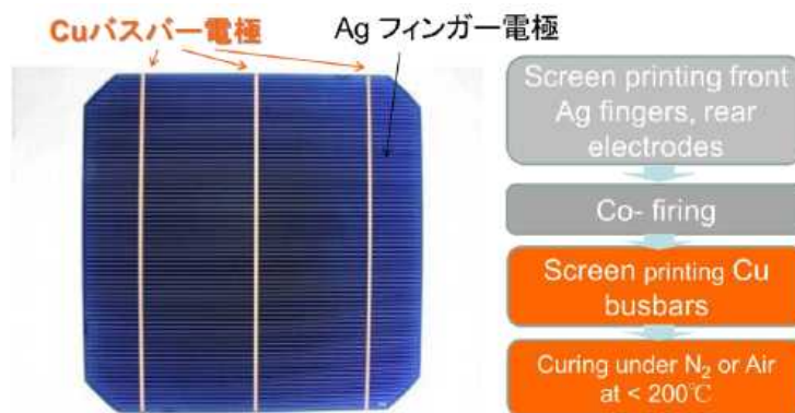
図Ⅲ-2-(イ)-A-1(70) Cu バスバー電極導入プロセス
