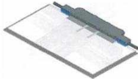
図Ⅲ-2-(へ)-G-1(44) 両面ガラス型モジュール用側面設置型ジャンクションボックスのイメージ図
