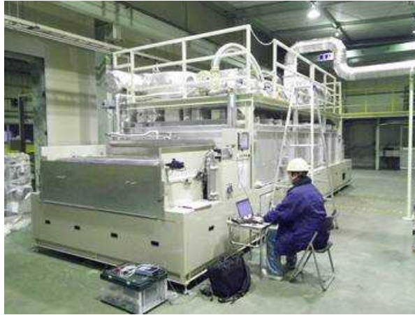
図Ⅲ-2-(へ)-E-1(2) EVA 熱処理装置 (装置全景)
