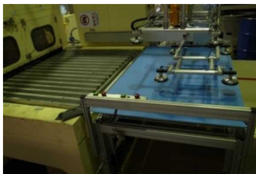
写真Ⅲ-2-(へ)-E-1(3) 吸着式基板移載装置（ロボット）
