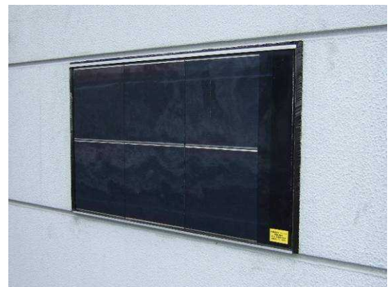
図Ⅲ-2-(ハ)-C-1(14) 環境試験結果と擬似構造モジュール(壁掛けタイプ)
