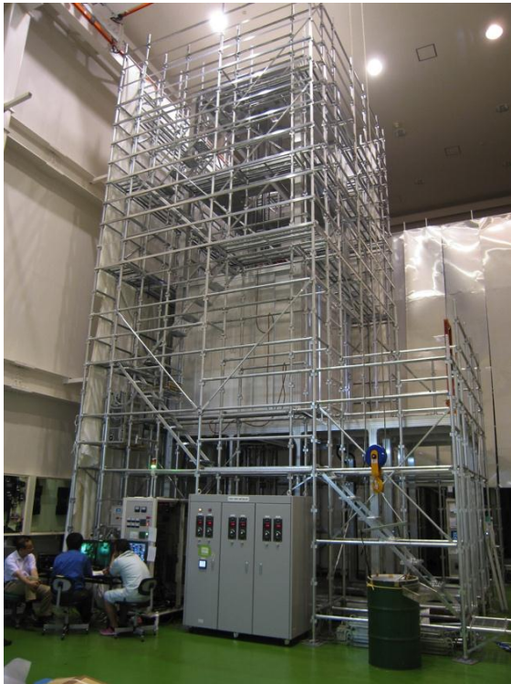
図Ⅲ-2-(イ)-E-1(1) 大型赤外線単結晶製造装置
