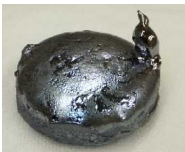
図Ⅲ-2-(イ)-A-1(45) ペレット 40 個を同時に融解・再凝固後した際の外観（左）および断面図（右）
