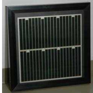
図Ⅲ-2-(ニ)-B-1(3) 25 cm角モジュールの外観
