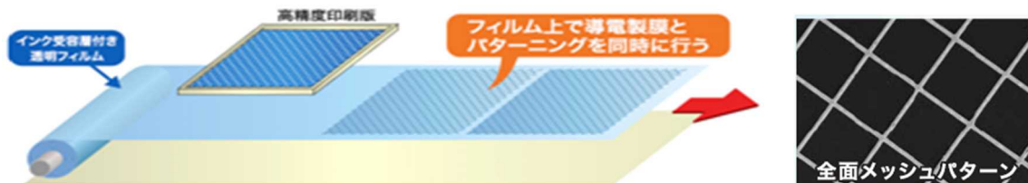
図Ⅲ-2-(ニ)-C-1(8) メタルメッシュ基板の製造例とメッシュパターン
