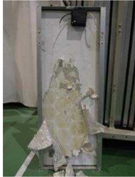
B. 20 年経過中古モジュール
