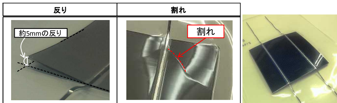
図 Ⅲ-2-(へ)-B-1(8). リジッド系太陽電池でのロールツーロールプロセス課題
