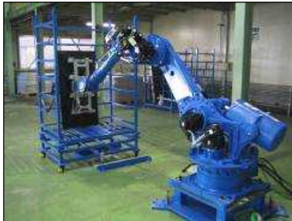
図Ⅲ-2-(へ)-E-1(4) モジュールローダー・アンローダー及びカセット
