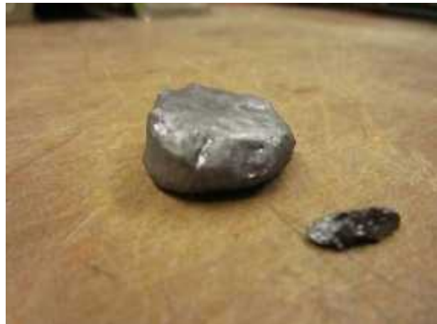
図Ⅲ-2-(イ)-D-1(6) 精製シリコンの外観
