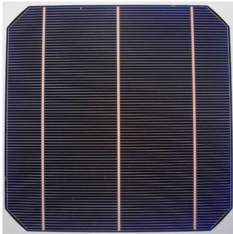
図 III-2-(イ)-F-1(8) 銅配線セル外観
