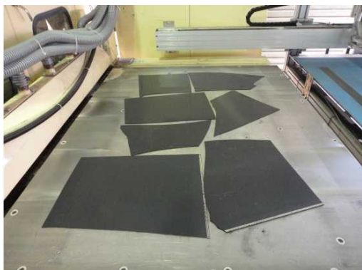
写真Ⅲ-2-(へ)-E-1(6) CIS 基板の吸着状況
