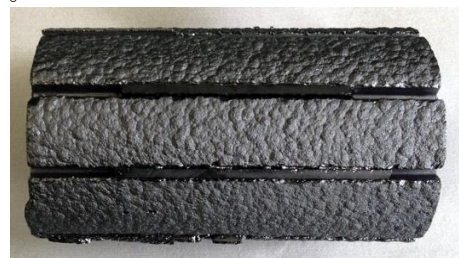
図Ⅲ-2-(イ)-E-1(3) トーパントを溶着した原料棒
