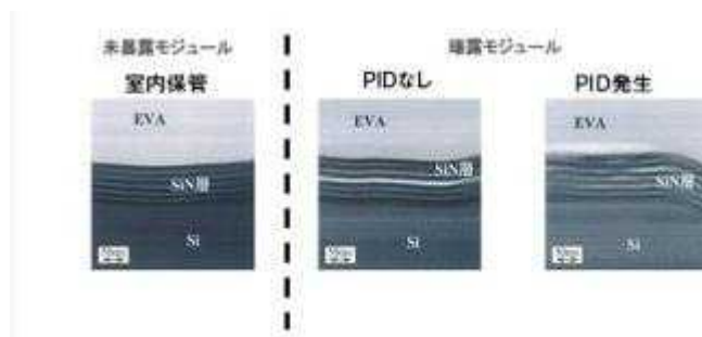
図Ⅲ-2-(へ)-G-1(58) 実フィールドで、PID 発症モジュールのシリコンセル反射防止膜(SiN 層)の断面構造
