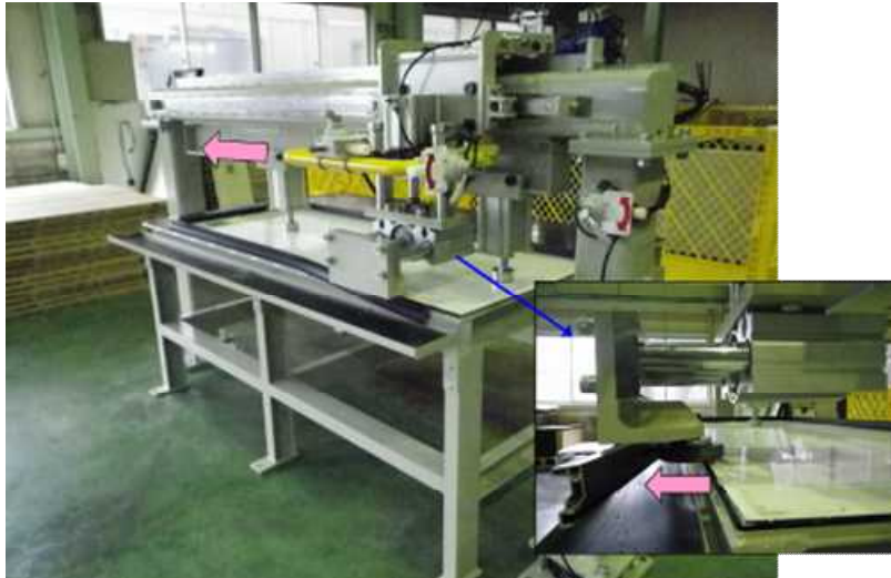
図Ⅲ-2-(へ)-E-1(7) 非加熱式アルミ枠解体支援装置
