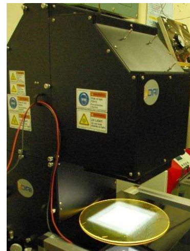
図Ⅲ-2-(へ)-H-1(34) 開発したソーラーシミュレータ
