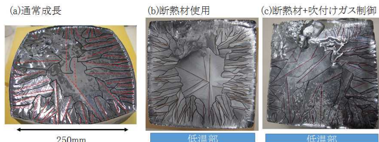
図 III-2-(イ)-A-1(26): 浮遊キャスト成長法によるデンドライト結晶の組織制御
