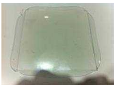
図Ⅲ-2-(へ)-G-1(11) 条件 D プレス時間 1.5min
