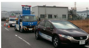
図5 簡易充填設備と公道充填 (模擬) 試験
