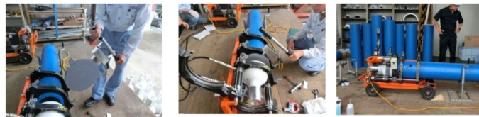
写真左より、熱板溶着の治具：中：熱板溶着板を挿入するところ。左：熱板溶着をしている所。熱板の温度、加圧条件は、次ページ条件表に記載。
