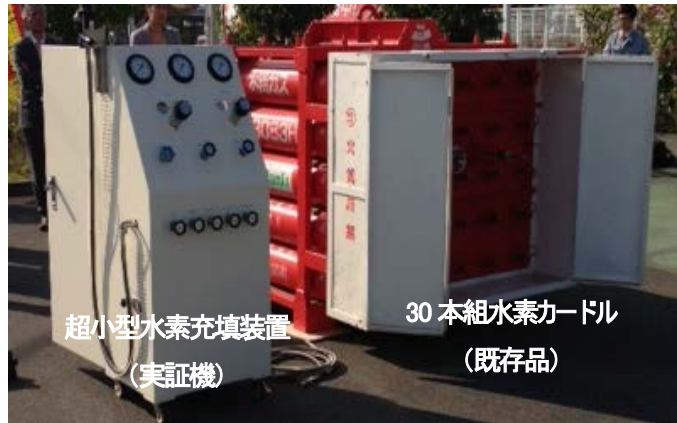
図7 超小型水素充填装置
