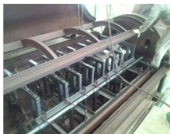
図 6 炉式成形機によるライナー成形状況
