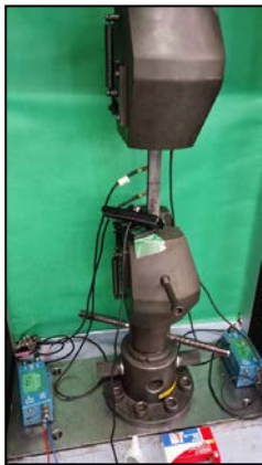
図 17 CFRP 引張破壊試験
