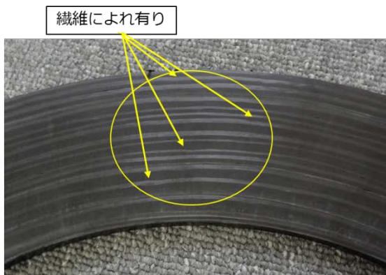
図 33 30L 提案当初の CFRP 補強
