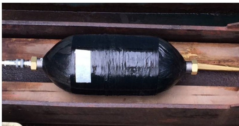
Fig.6 圧力サイクル試験後の容器外観
