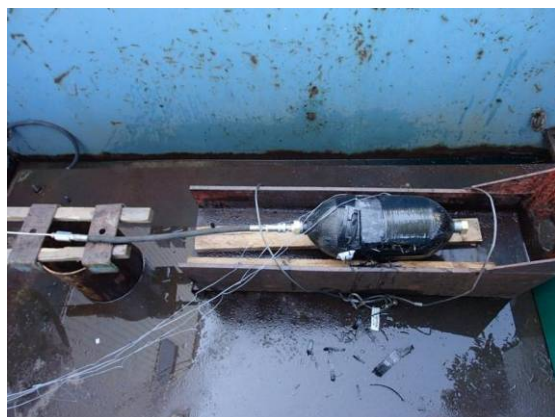
Fig.3 破裂試験前の容器外観
