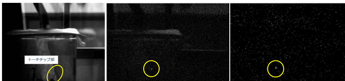
図5 近赤外画像（左端：766nm、中央：930nm、右端：両画像の差分）
