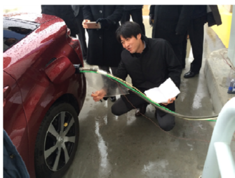
写真1 ホース曲げR計測風景
