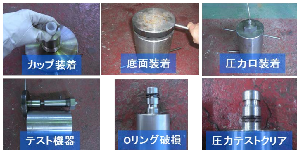
図 28 口金部シールテスト状況
