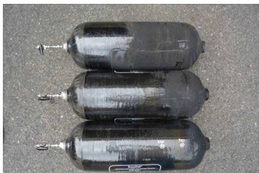
容器が破裂する直前に水をかけて冷却した容器 (加熱後容器)
