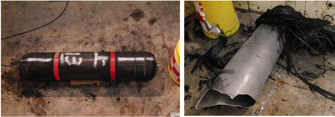
焼損容器の残存強度確認試験
