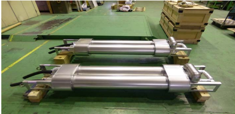
図1. 熱交換器ユニット外観（1ユニットに熱交換器2基を格納した状態） 熱交換器の研究開発は、計画通りの成果を達成した。
