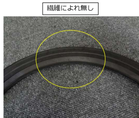
図 34 30L 改良した CFRP 補強
