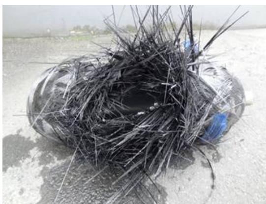
図11 新TPP-C 7.5L容器 破裂試験後
