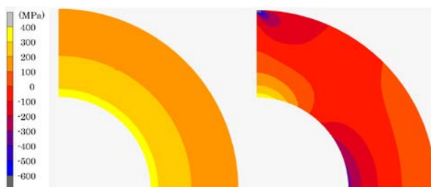
(a) 内圧 200MPa の場合 (b) 線荷重 4kN の場合
