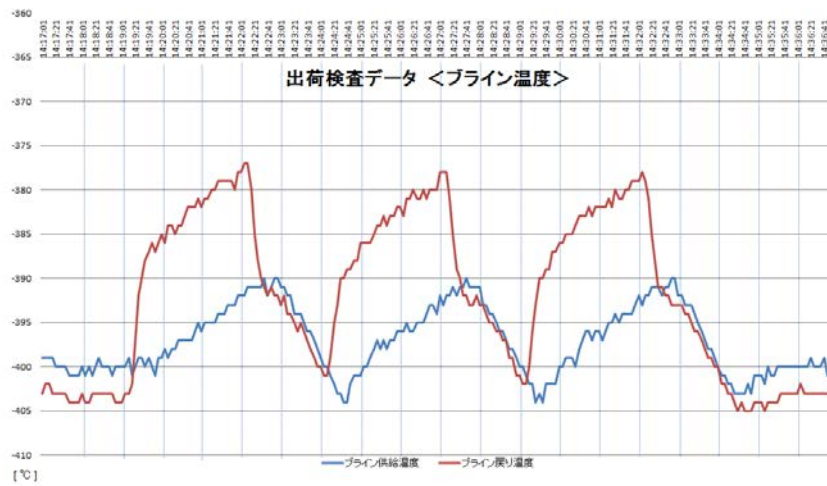
図 3. ブライン温度測定（定格運転時）結果
