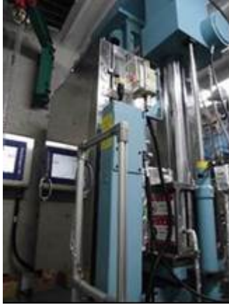
図 12 140MPa 高圧水素ガス雰囲気下材料試験機(試験ガス圧力:140 MPa、試験温度:RT ~ 300℃、負荷容量:±100kN)
