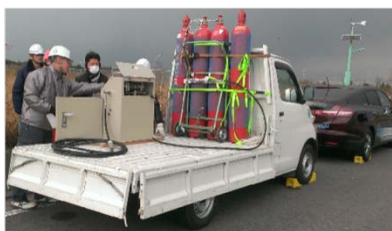
図5 簡易充填設備と公道充填 (模擬) 試験
