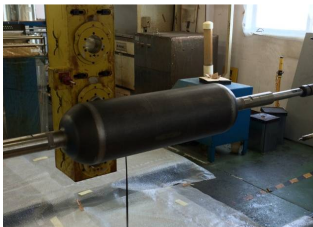
Fig. 7 スチールライナを FW 装置に装着して、炭素繊維の FW を実施する前の状況
