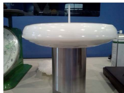
図 27 口金をインサートした口金ブロックの製作状況
