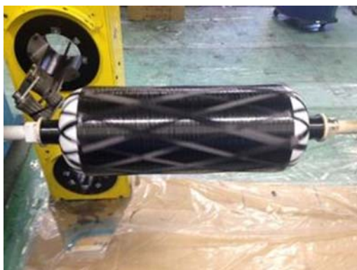
図10 新TPP-C 7.5L容器 破裂試験後
