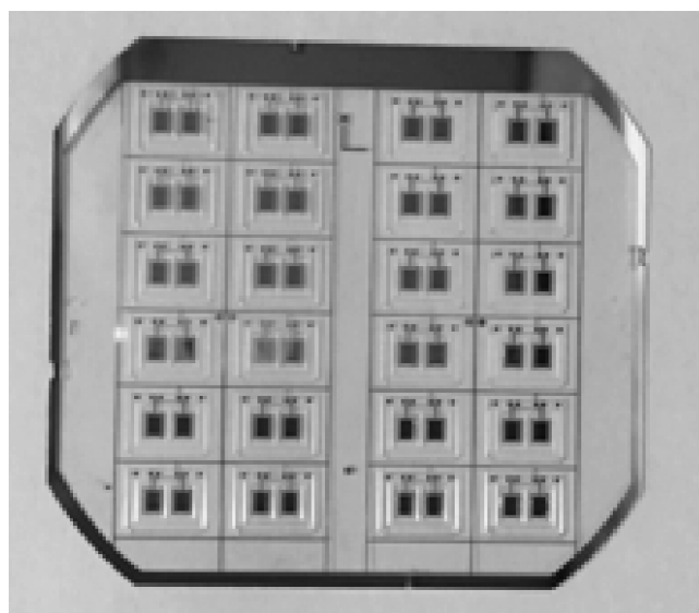
図5 センサ加工後の水晶ウェハ (ウェハ寸法: 48 mm×44 mm)
