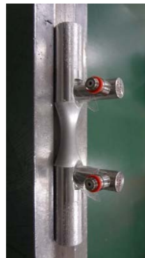
図4 AE センサ取付状況
