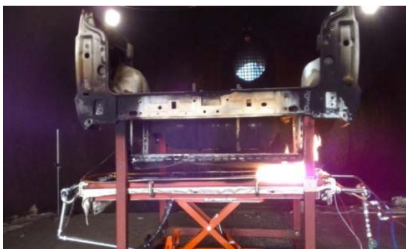
車載容器の局所火炎暴露試験
