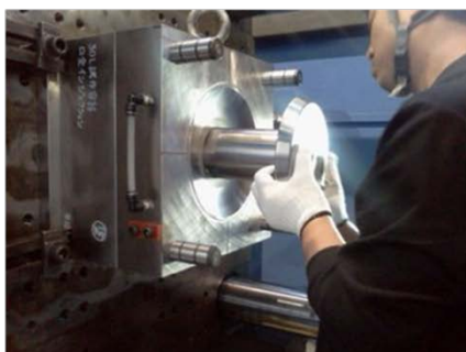
図 27 口金をインサートした口金ブロックの製作状況
