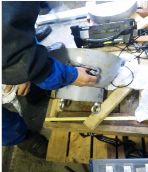
図 1 超音波探傷検査
