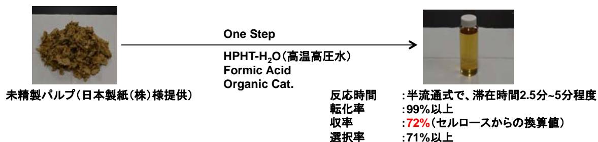
図Ⅲ-2.2.3-6 未精製パルプから HMF への変換反応
