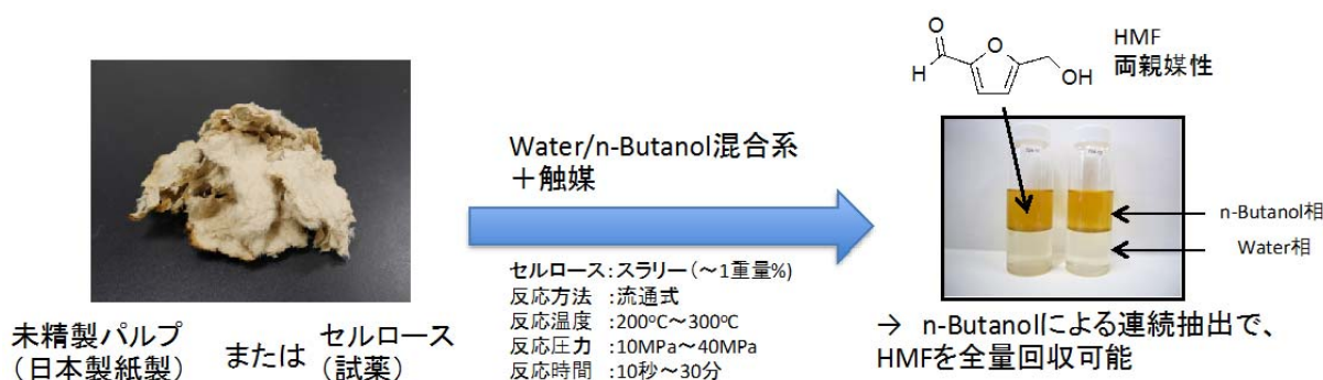
図Ⅲ-2.2.3-7 未精製パルプから HMF の連続合成
