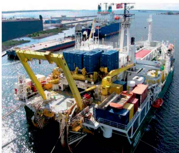
図 3.7.2-82 海底ケーブルの積み出し状況(日本産業機械工業会, 2010)
