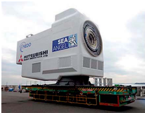
図-3 SEA ANGEL 三菱重工業 7.0MW (油圧ドライブ+同期式発電機 : NEDO HP)
