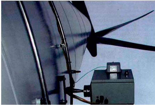
図 3.5.2-12 赤外線探知機の設置状況 (Desholm and Kahlert, 2005)
