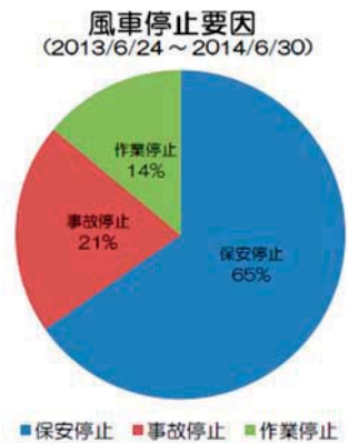
図 3.8.3-15 洋上風車の運転実績と風車停止要因(2013. 6. 24~2014. 6. 30)(電源開発資料)
