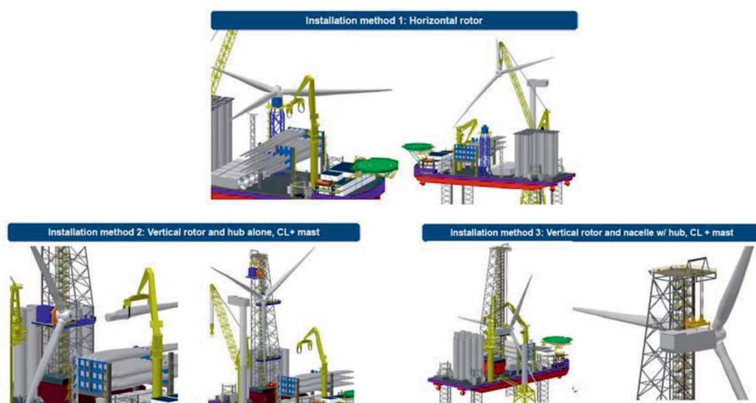
図 3.7.2-52 従来型(上図)と新提案(下図)の風車設置方法(Mortensen et al. , 2011)
