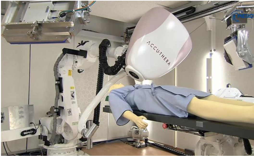
国立国際医療研究センターの評価室に統合した高精度X線照射装置
