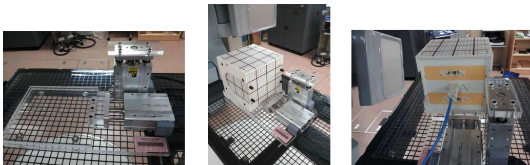
(左) 開発した検証用動体ファントムの外観。(中) 動体ファントムを用いたフィルムによる線量分布評価。(右) 動体ファントムを用いたチェンバによる線量検証。
