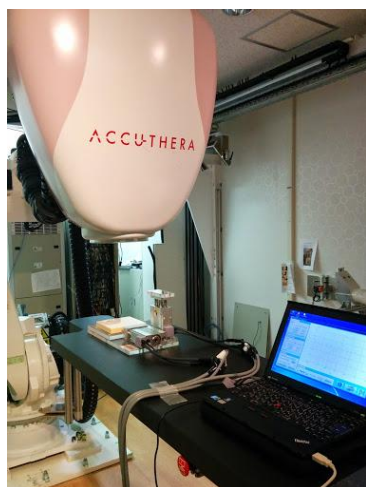
動体ファントムを用いたフィルム照射試験による統合システムの評価。
