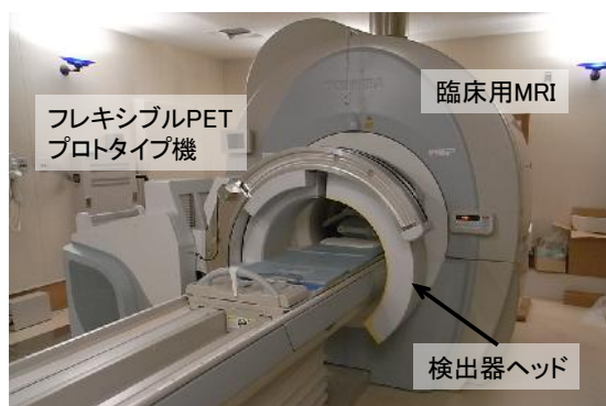
フレキシブルPETと臨床用MRIの組み合わせ
