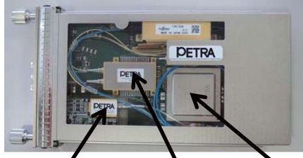
試作CFPトランシーバ内部構造
