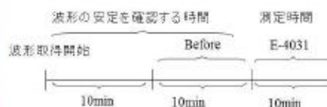
図12. ヒト幹細胞由来心筋塊(CMC)の活動電位測定プロトコール(カレントクランプ・微小電極報)
