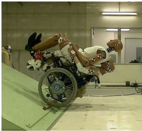
図4. 6. 4 ダミーによる車いすの転倒試験
