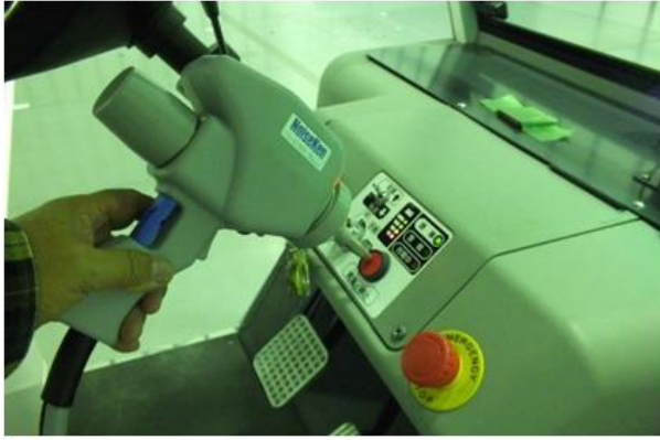
図表 5-7 静電気試験（気中）の印加ポイント
