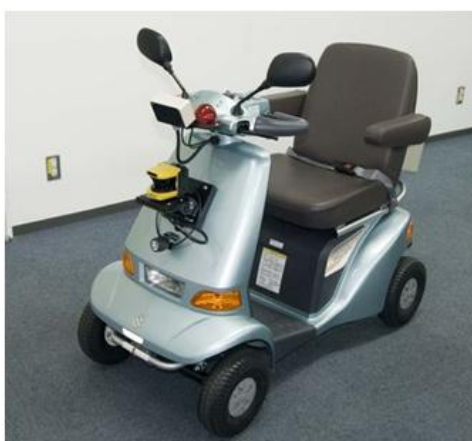
図表 6-4 段差検知センサを搭載したハンドル型電動車いす
