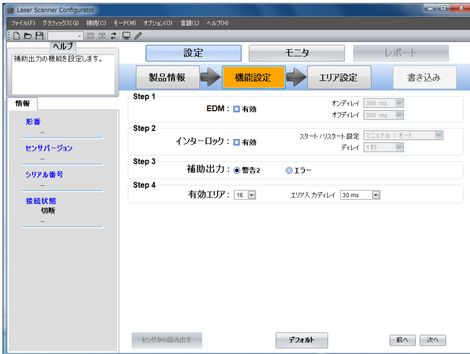
図表 2-8 屋外対応 3 D レーザスキャナの機能設定
