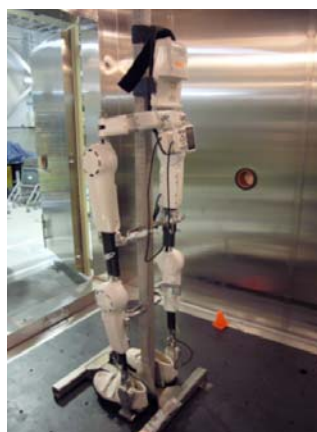
図 4 振動試験の様子
