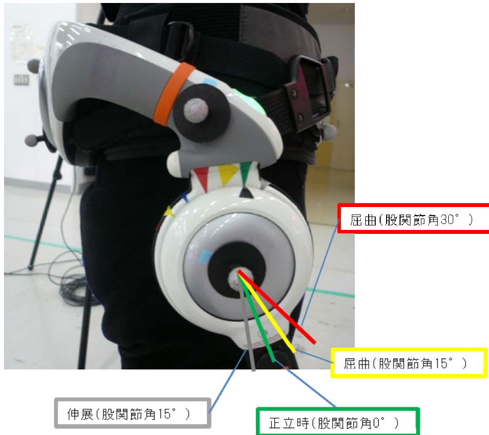
Figure 2.2-20 改造した歩行アシストとロック位置
