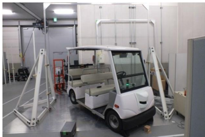
図表 5-9 の対電源周波数磁界妨害耐性の様子
