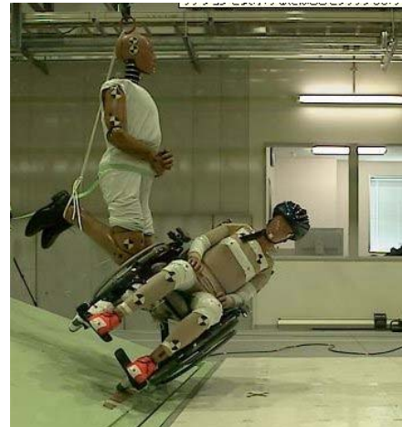
図4. 6. 4 ダミーによる車いすの転倒試験
