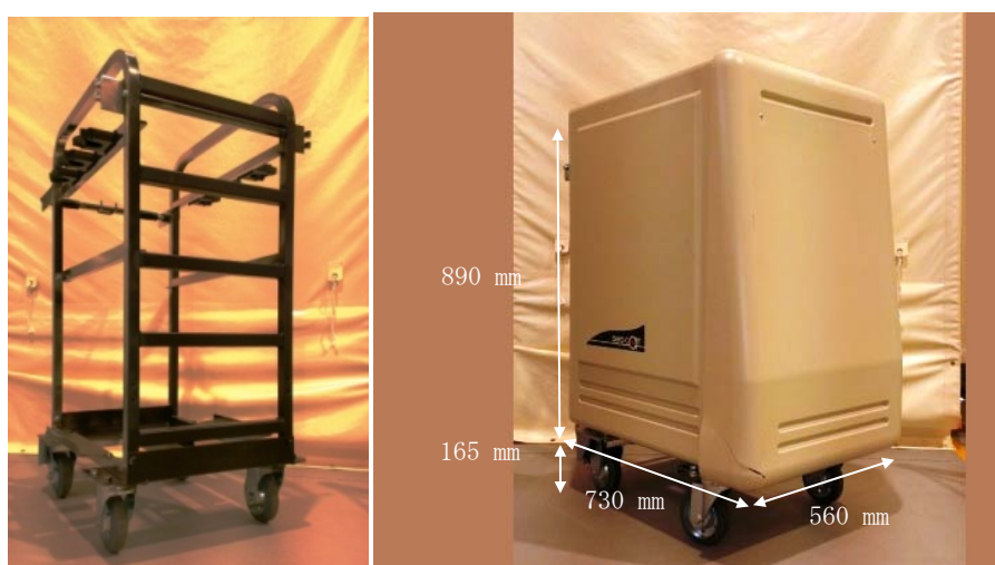
図 4.2.4.4-1 移動作業型ロボットを模した移動体
