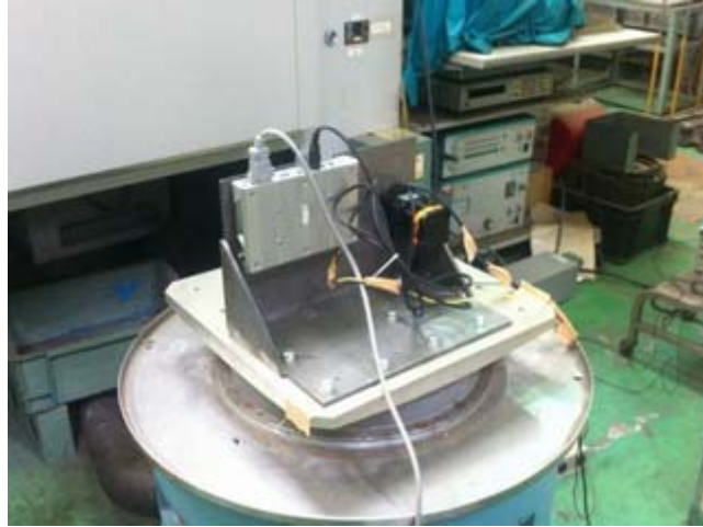
図 5.3.5-3 レーザースキャナの振動試験
