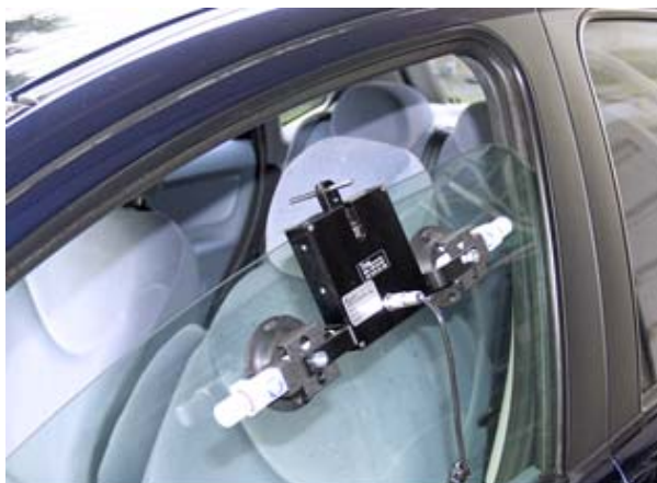
図4.2.5-4 パワーウィンドウの挟圧安全性試験の例 （図は Sensor Developments, Model 10293）
