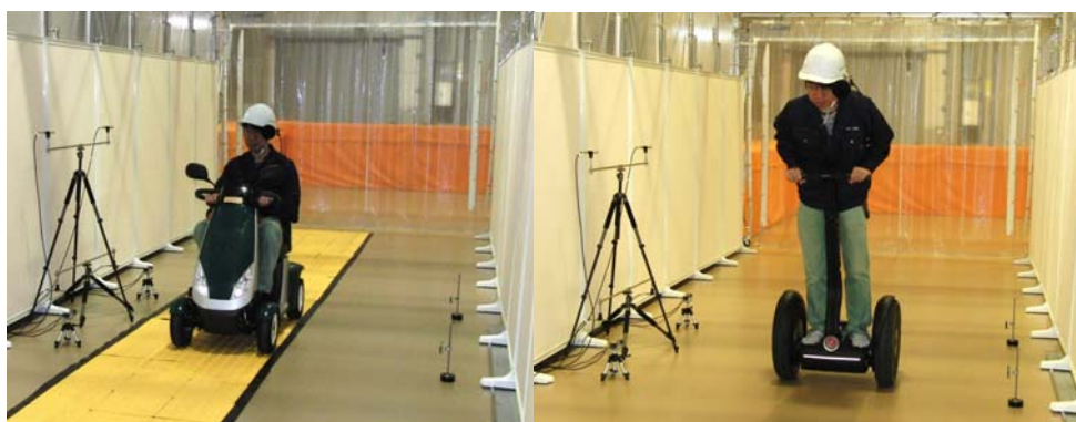
図 4.2.2.4 模擬ロボットによる騒音試験の様子 （左がハンドル型電動車いす、右が電動立ち乗り二輪車）
