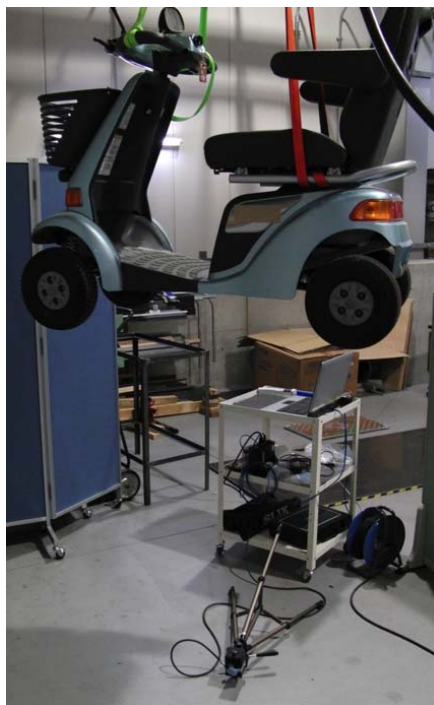
図 4.2.3.2 電動車いす底面の温度測定の様子 (床面上の三脚先端部がサーモグラフィのカメラ部)
