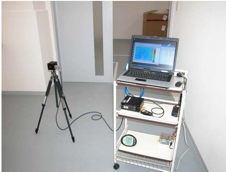
図 4.2.3.1 FSV-1100 と専用ソフトウェアをインストールしたノート PC の接続状態
