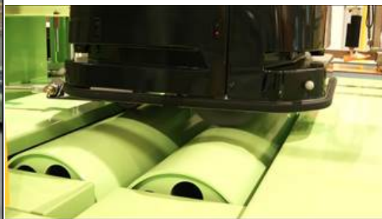
図 4.3.2-4 車輪移動型ロボットの固定例
