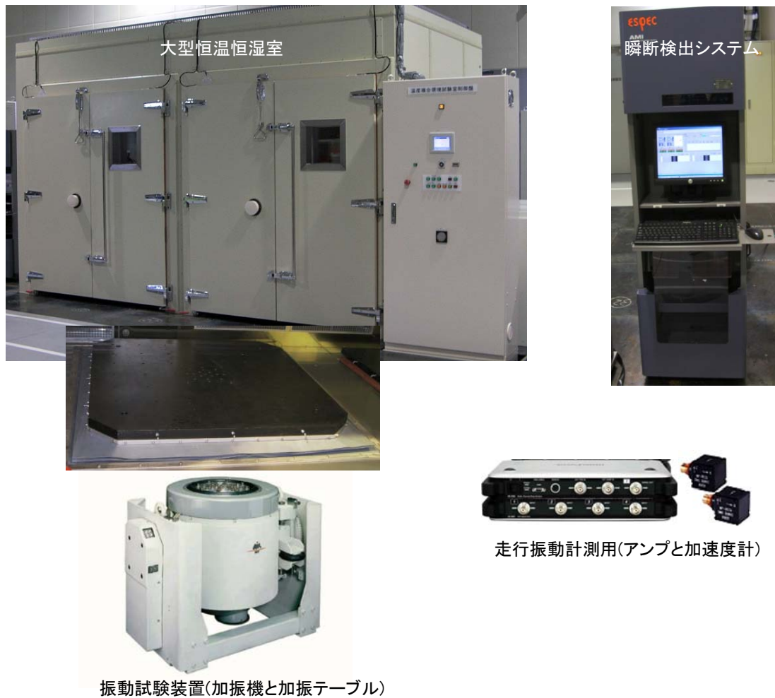
図 4. 3. 1. 1 複合環境試験設備の構成装置
