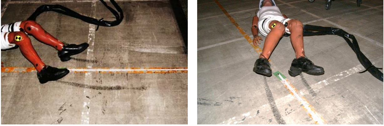
図 6.3.1-11 ダミー移動時の踵の擦過痕と破損した靴の踵
