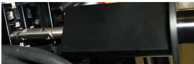
図 4.2.1.3 接合型標準テストフィンガを用いた接触可能性部位の探索
