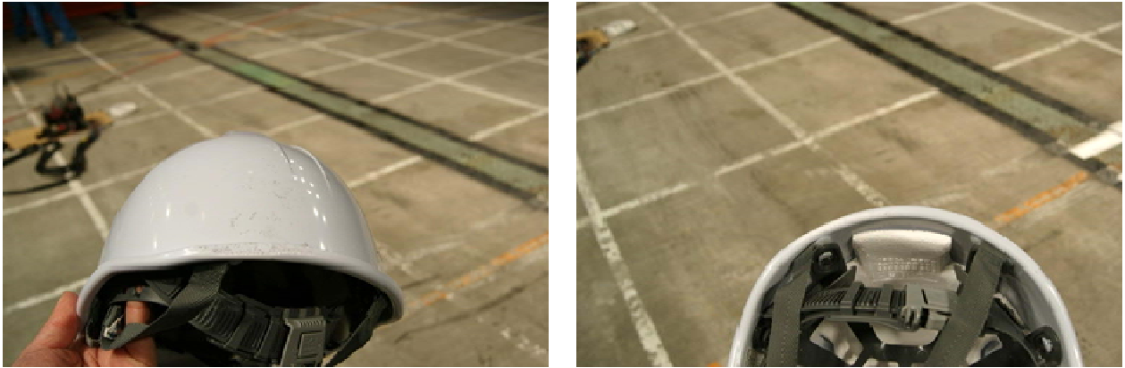
図 6.3.1-5 衝突後のヘルメットの変形
