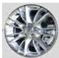
図 5.3.8-5 同期タイミングによる 3 次元データのブレ
