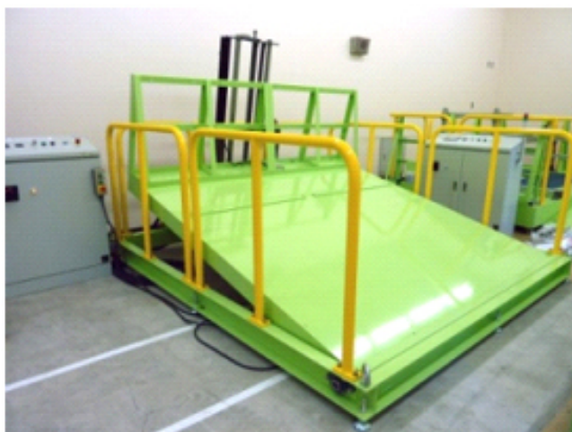
図 4.1.1-1 静的安定性試験装置
