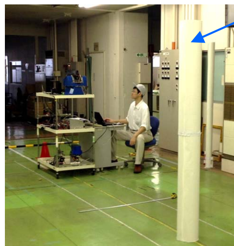
図 6.1.4-5 3次元障害物センサー単体試験 (位置精度試験)
