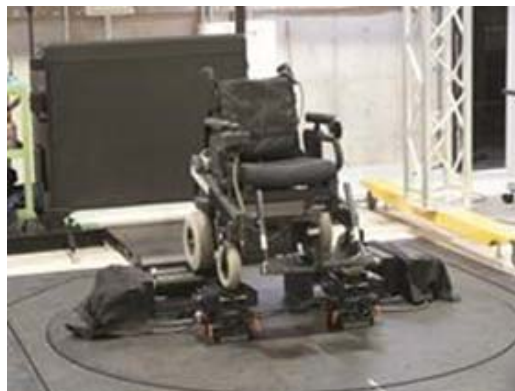
図 4.5.2-4 ロボット走行状態模擬装置
