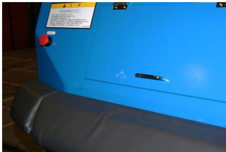
図 6.3.1-6 衝突後のヘルメットによる車体の塗装傷
