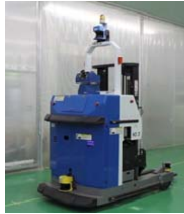
図 5.3.4-3 安全サポート系の取り付け
