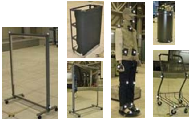
図 4.5.2-3 各種障害物（壁，円筒，人体ダミー）の例
