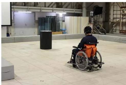
図 4.5.2-7 障害物（円筒 黒 φ600）の試験の様子
