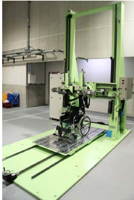
図 4.3.3-1 耐荷重試験装置
