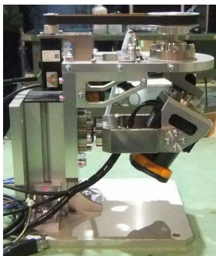
図 5.3.8-10 1リンク揺動機構 機構部
