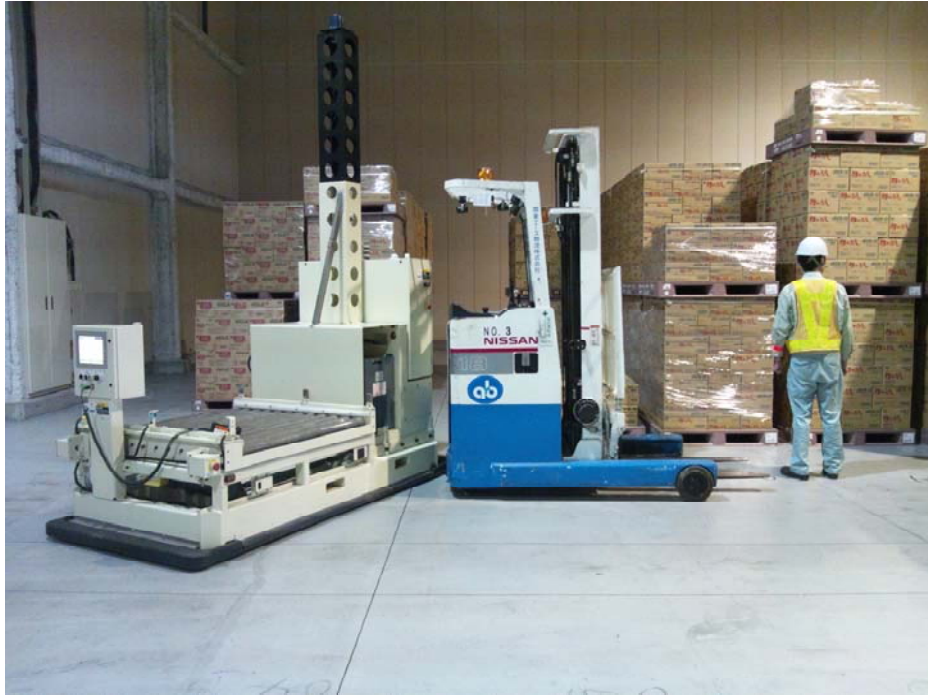
図 4-4 AGV とフォークリフトとの接触
