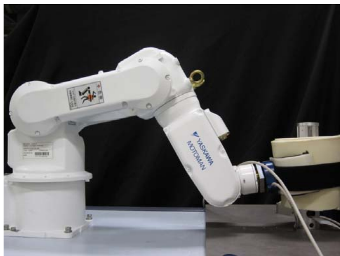
図 4.2.6 - 13 接触安全性試験概観
