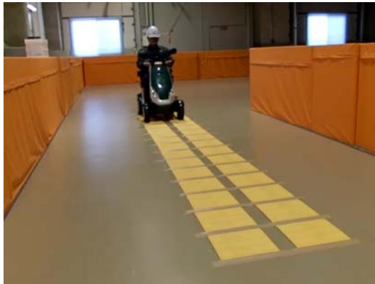
図 4. 3. 1. 3 電動車いすの実走行波形取得の様子
