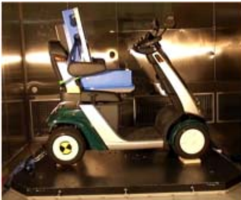
図 4. 3. 1. 4 加振テーブル上で空走する 電動車いす
