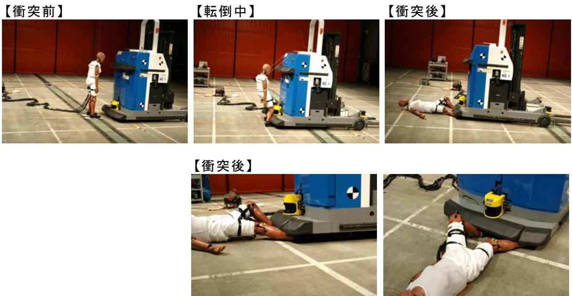
図 6.3.1-4 180m/分での衝突時の挙動
