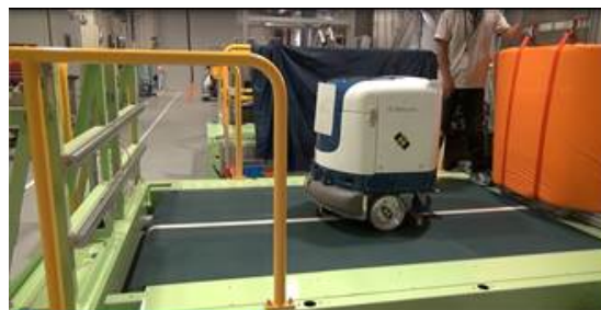
図 4.3.2-8 位置制御装置の応答特性試験
