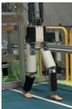
図 4.3.2-15 装着型生活支援ロボット耐久性試験装置
