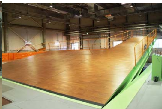
(b) 傾斜路走行試験設備
