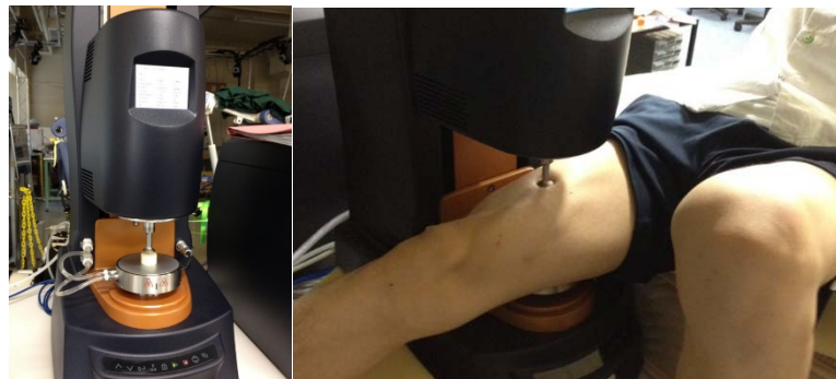
図 4.2.6 - 6 レオメータおよび人体皮膚特性計測実験配置
