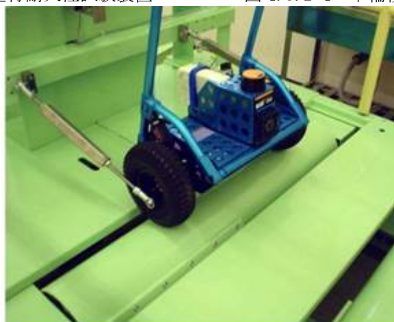
図 4.3.2-5 試験装置の搭乗型移動ロボット固定治具とレイアウト
