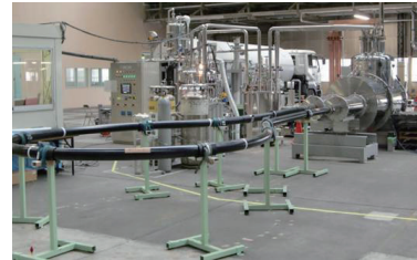
高性能イットリウム系線材適用66kVケーブル通電試験((株)フジクラにて実施)
