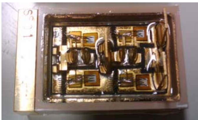
図Ⅲ.2.3.2.2-36 日立製 SiC デバイスチップを 使った All-SiC パワーモジュール SiC-JFET と SiC-SBD を 各 4 個内蔵する
